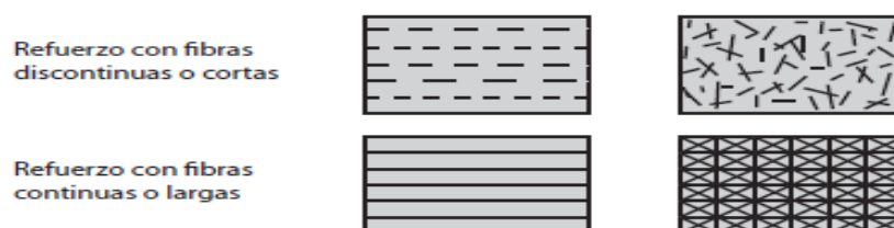
Figura 23 Clasificación de los materiales compuestos por tipo, orientación y geometría al refuerzo
