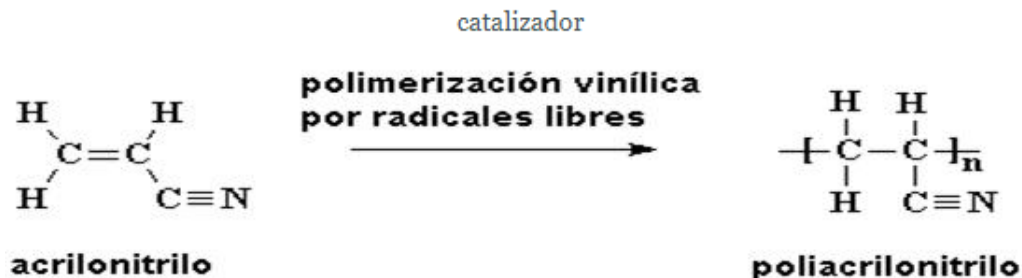
Figura 27 Obtención del poliacrilonitrilo
