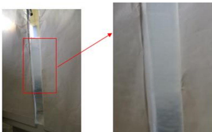
Figura 43 Deposición de fibras alineadas de PVP en placas paralelas con separación de 2,0 cm
