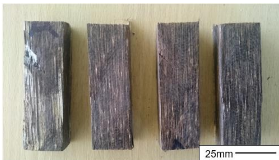
Figura 32 Muestras iniciales a partir del borde externo del tronco de chonta. Dimensiones aproximadas de 25 x 15 x 80 [mm].
