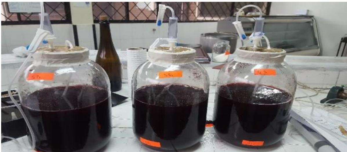
*Figura 4* Tanques fermentadores de 4L., llenos 2/3 de su capacidad con mosto en fermentación
