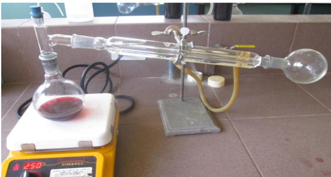
*Figura 7* Equipo de destilación básico armado para destilar vino de mortiño
