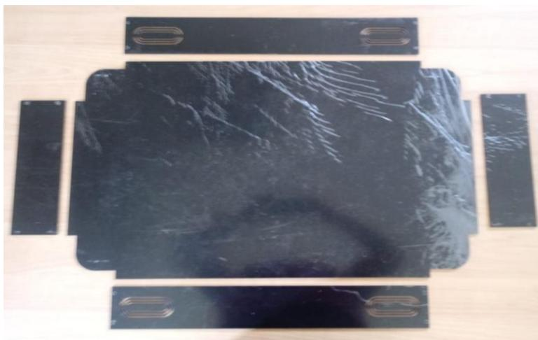
**Figura 50** Corte laser correspondiente a la cubierta inferior
