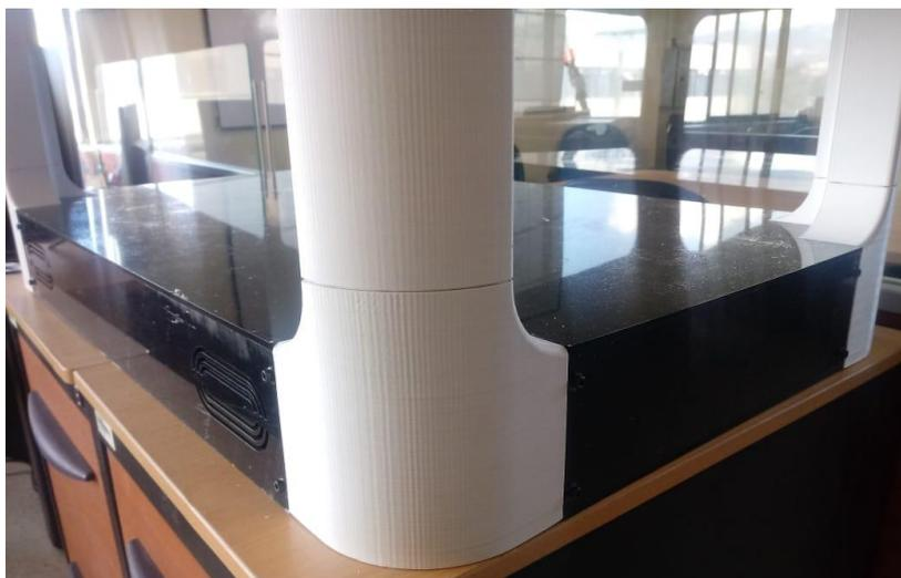
**Figura 56** Ensamble cubierta inferior del equipo
