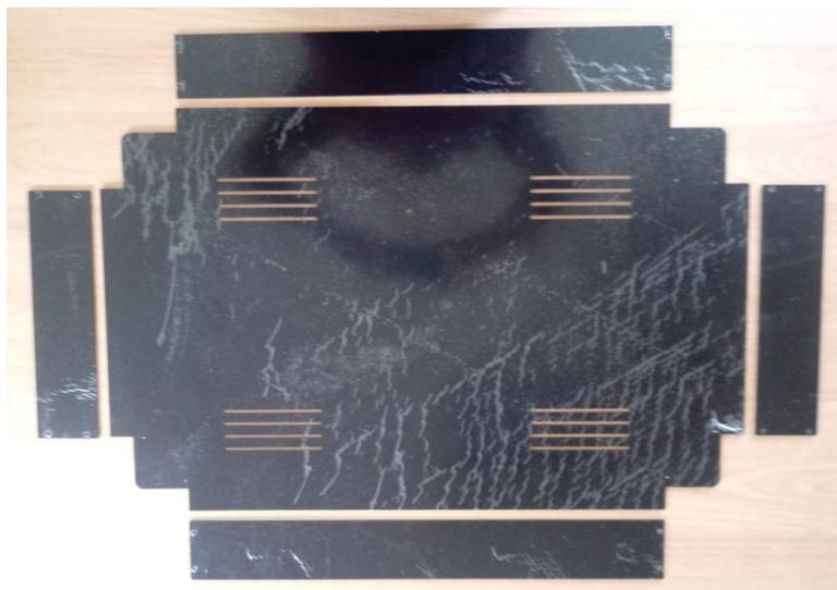
**Figura 51** Corte laser correspondiente a la cubierta superior
