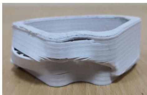
**Figura 71** Probeta de prueba de resistencia a compresión
