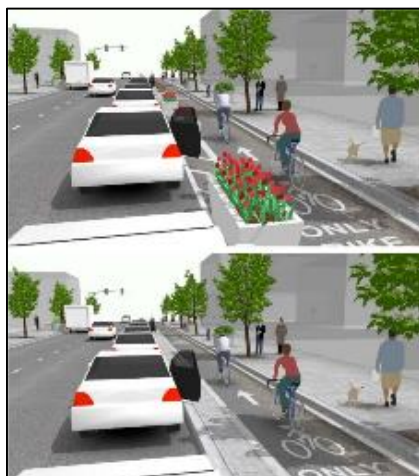
Figura 5. Señalización de ciclovía propia con espacio de seguridad
