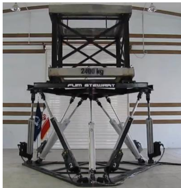
Figura 20 Simulador de Vuelo FUM 2400Kg
