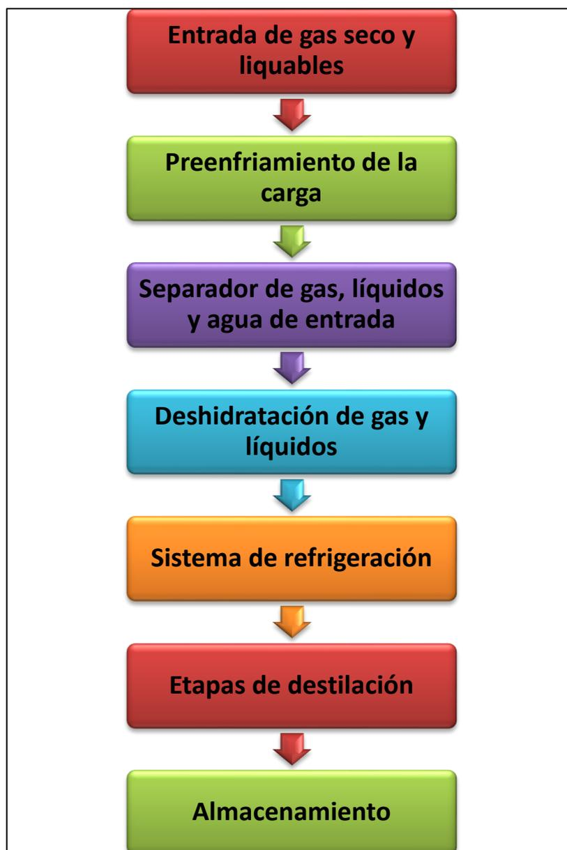
*Figura 1. Proceso de obtención del GLP*
