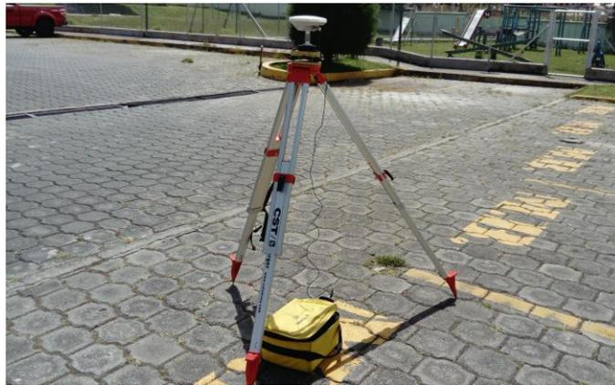
*Figura 8.* Toma de puntos de control GCP.
