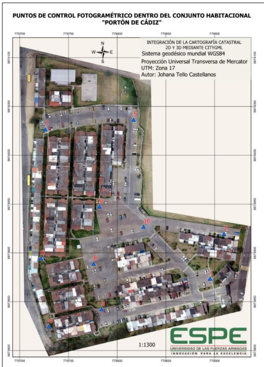
**Figura 46.** Distribución de puntos de control fotogramétrico dentro del área de estudio.
