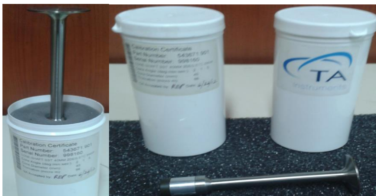
Figura 19. Geometría de cara plana con 40 mm de diámetro y 2 ° de inclinación.
