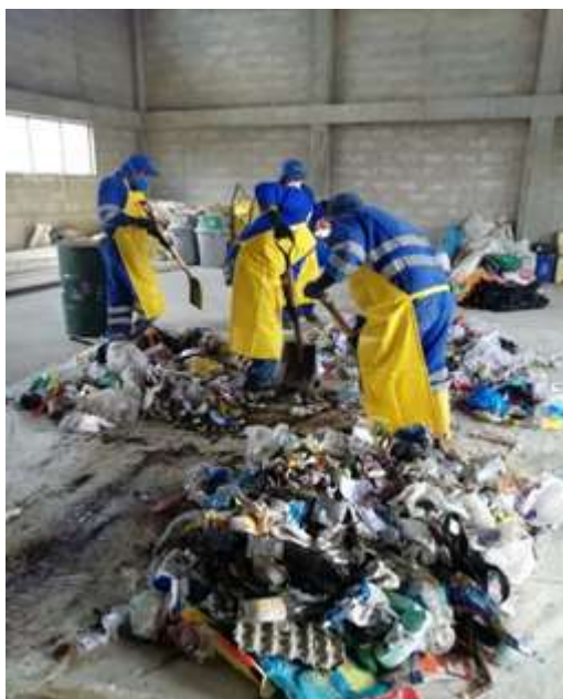
Figura 20 Aplicación del método de cuarteo
