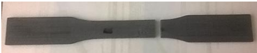
Figura 39 Rotura de la Probeta Z PLA
