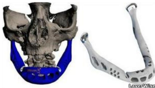
Figura 10 Implante fabricado con polvo de titanio Fuente: (Wauthle, 2012)
