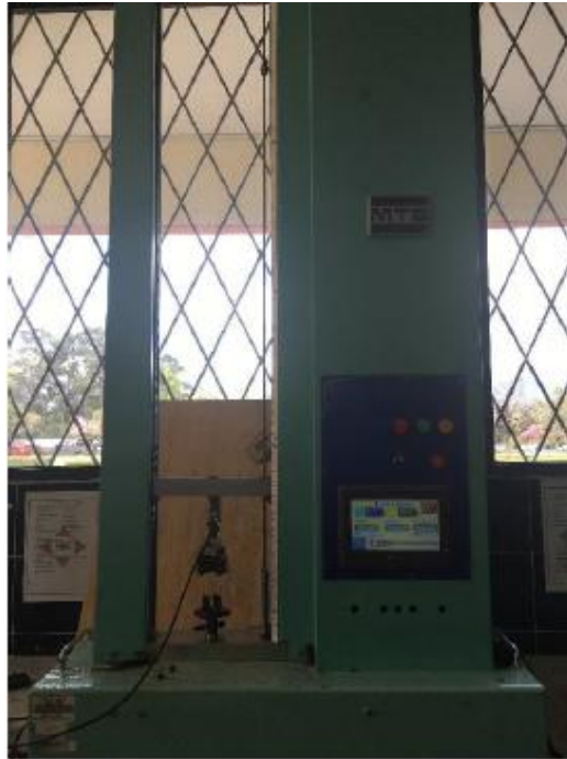
Figura 41 Máquina de ensayos universales MTS Fuente: (Laboratorio de resistencia de materiales - ESPE)
