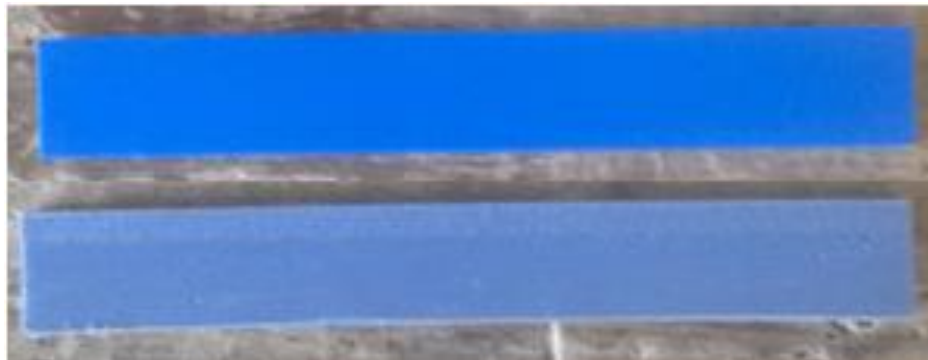
Figura 34 Probetas para el ensayo de flexión
