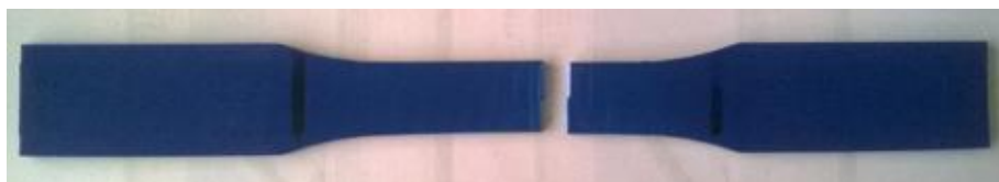
Figura 36 Rotura de la Probeta Z ULTRA T
