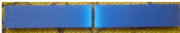
Figura 42 Rotura de la Probeta de flexión
