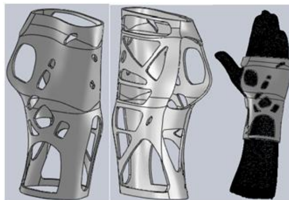
Figura 75 Rediseño de la férula mediante CAD
