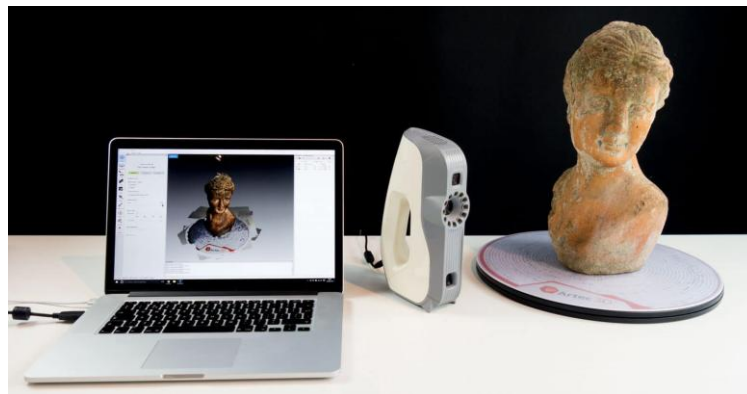
Figura 17 Scanner 3D de luz estructurada Fuente: (Artec3D, 2018.)
