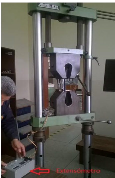
Figura 35 Máquina AMSLER y extensómetro MTS Fuente: (Laboratorio de resistencia de materiales, ESPE)
