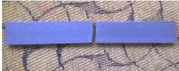
Figura 45 Rotura de la Probeta Z PLA
