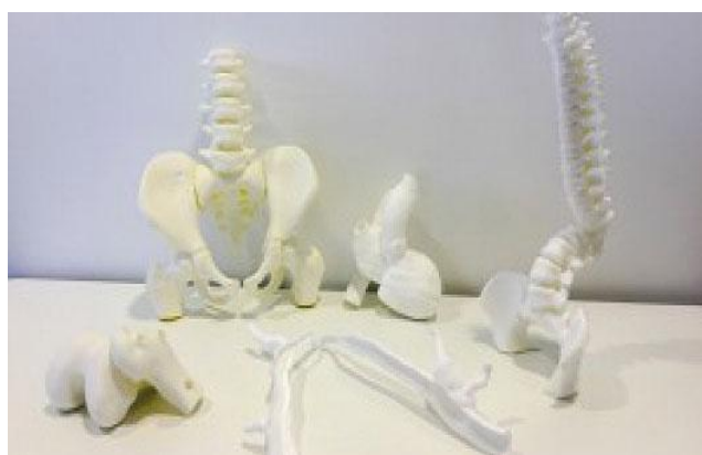
Figura 11 Huesos impresos mediante 3D basados en un TAC Fuente: (Mizar additive, 2016).
