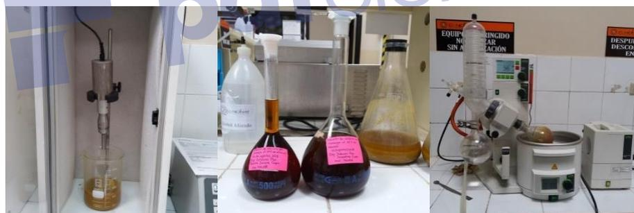
**Figura 7.** Extracto sonicado, filtrado y concentrado en el rotavapor
