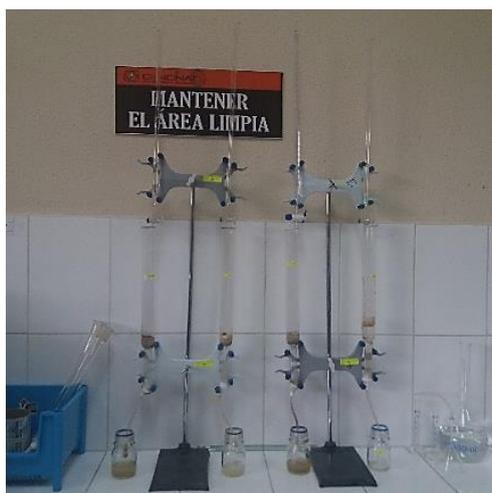
**Figura 10.** Prueba de retención con 2 g de Tecnosol
