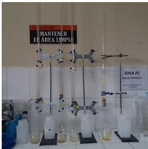
*Figura 11.* Prueba de retención con 10 g de Tecnosol
