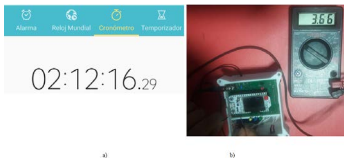
Figura 137. Voltaje de la batería cargada, Prueba A
