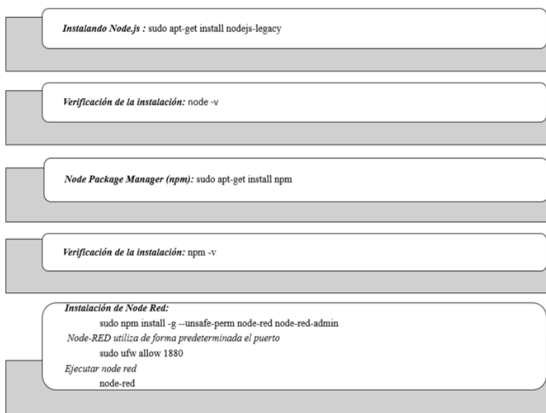
Figura 36. Instalación de Node-RED.
