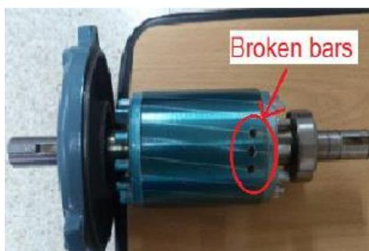
**Figura 2.** Simulación de barras rotas en el rotor
