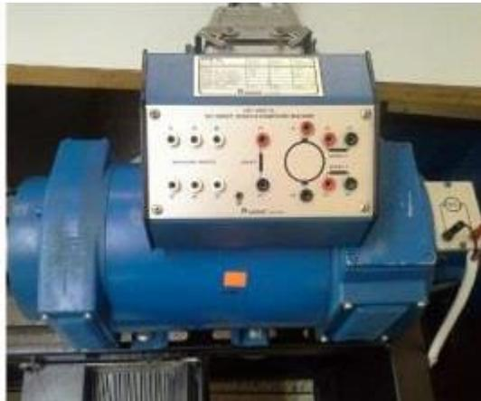
**Figura 4.** Generador DC para la simulación de carga
