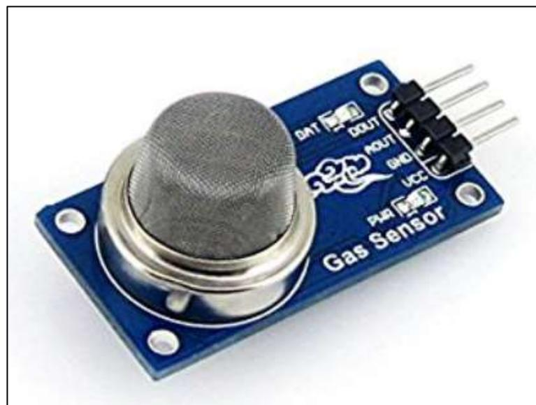
*Figura 24* Sensor de Humo/Gas MQ-2
