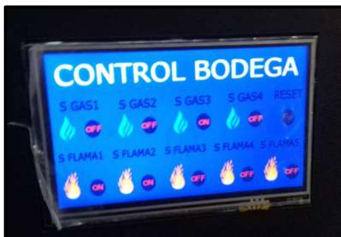
Figura 37 Visualización en la interfaz HMI
