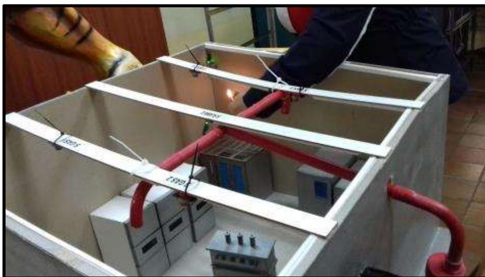
*Figura 38 Pruebas a los detectores de Flama con fuego real*
