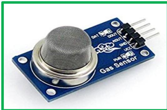
La tarjeta del sensor cuenta con dos salidas de datos, una digital (DO) y otra analógica (AO) y es compatible con la plataforma Arduino
