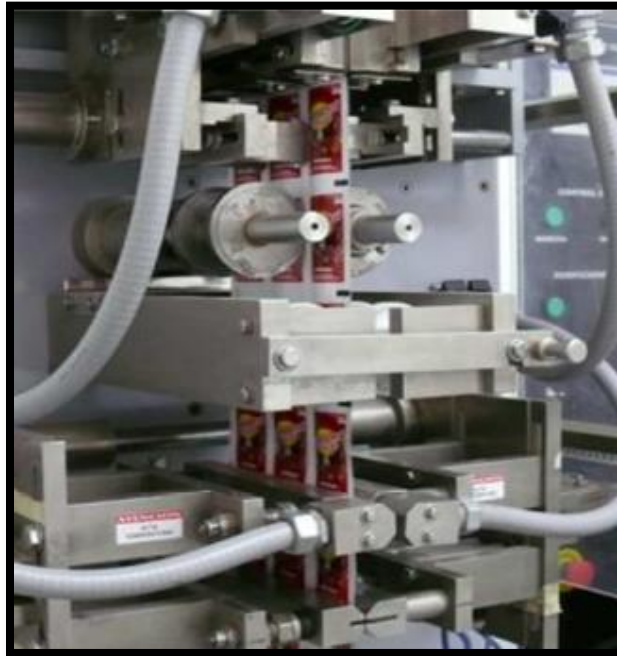
Figura 16. Sistema de arrastre por tornillos
