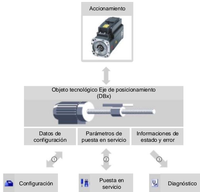
**Figura 7.** Interacción de las herramientas con el objeto tecnológico eje de posicionamiento y el accionamiento.
