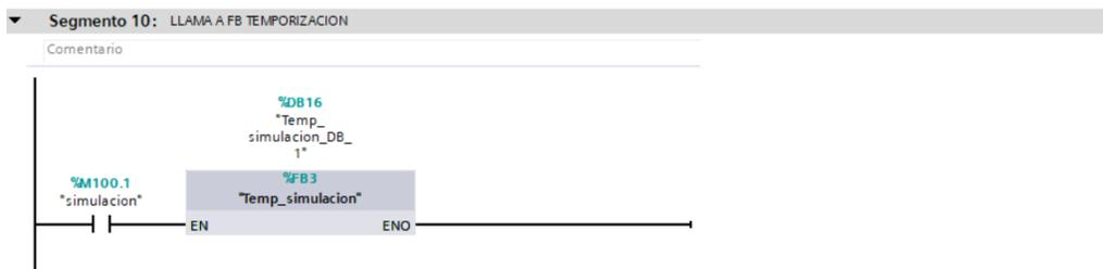
**Figura 63.** Ejecución al bloque de función "Temp\_simulacion"
