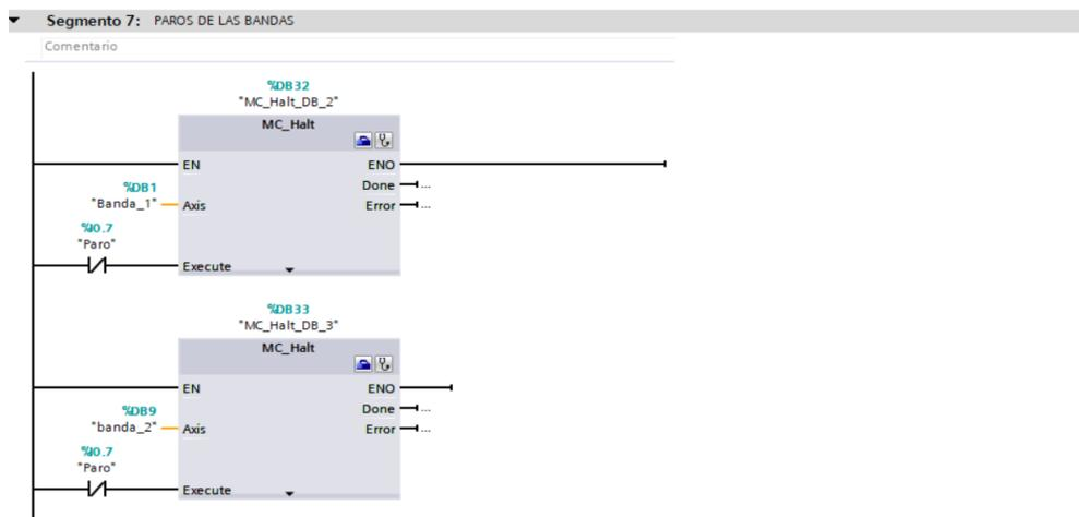
**Figura 60.** Segmento para frenado e interrupción de las Bandas 1 y Banda 2
