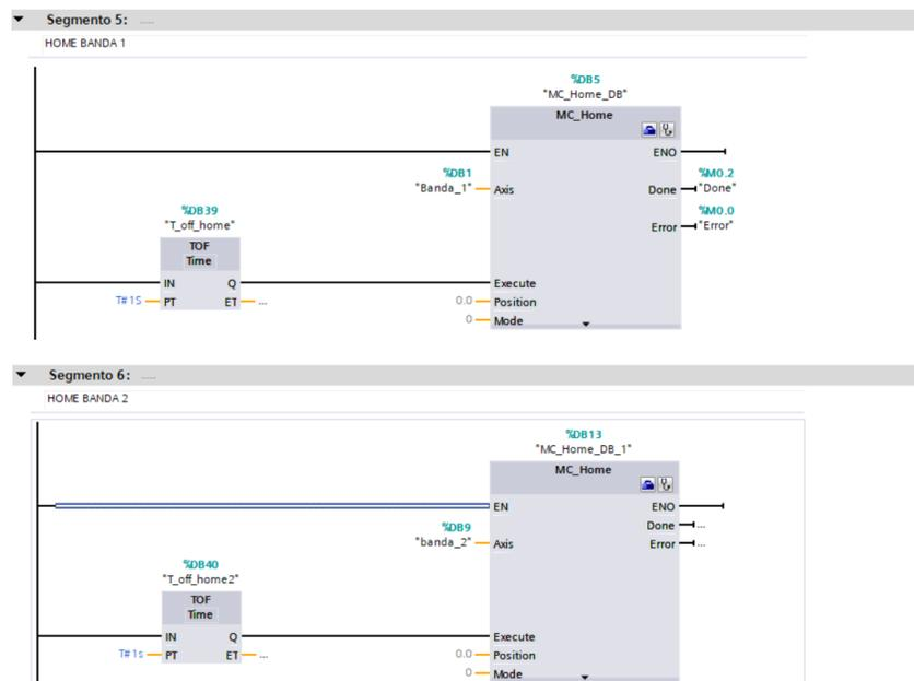
**Figura 59.** Referenciación de los ejes (Banda 1 y Banda 2)
