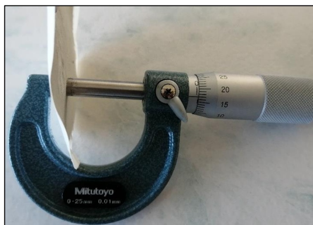
Figura 34. Medición de espesor de revoque.
