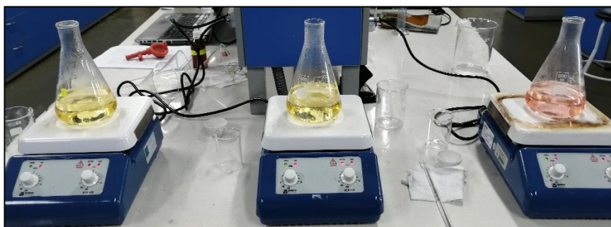
Figura 16. Neutralización y sub-acidez de solución tratada.
