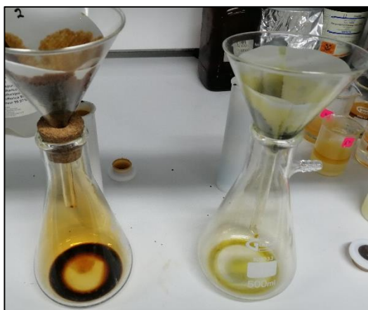
Figura 22. Filtración de ácidos posterior a la digestión.
