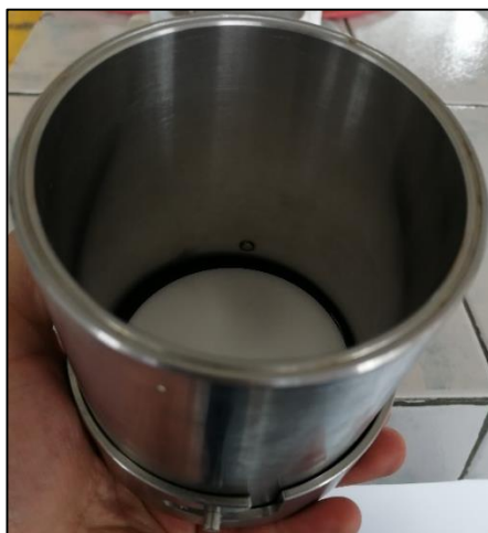
Figura 33. Colocación de celda de filtrado API.
