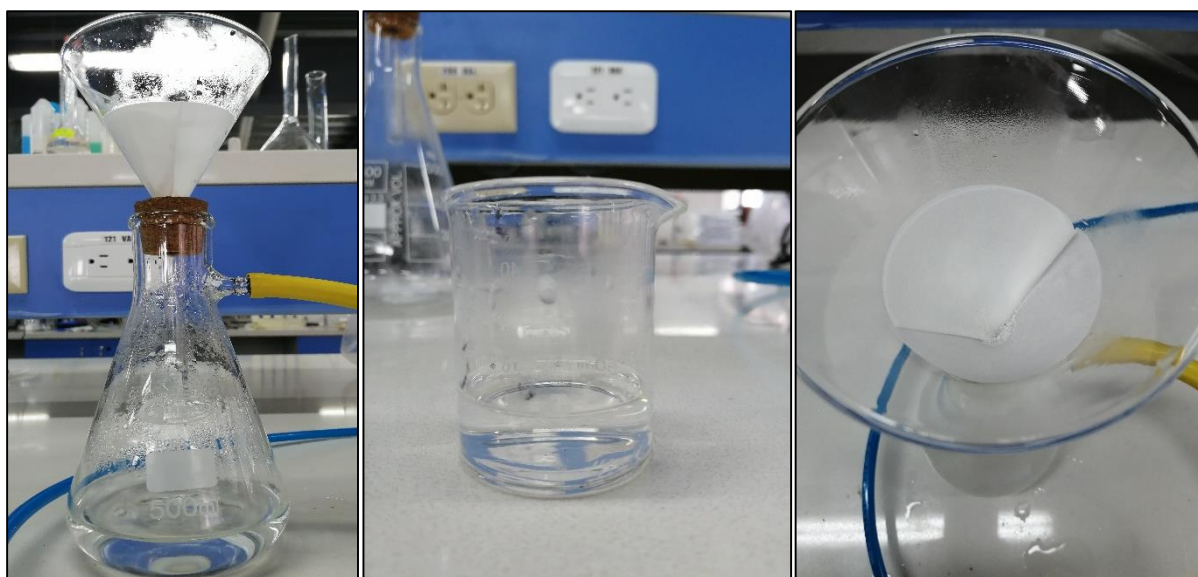
Figura 17. Filtración de precipitados.
