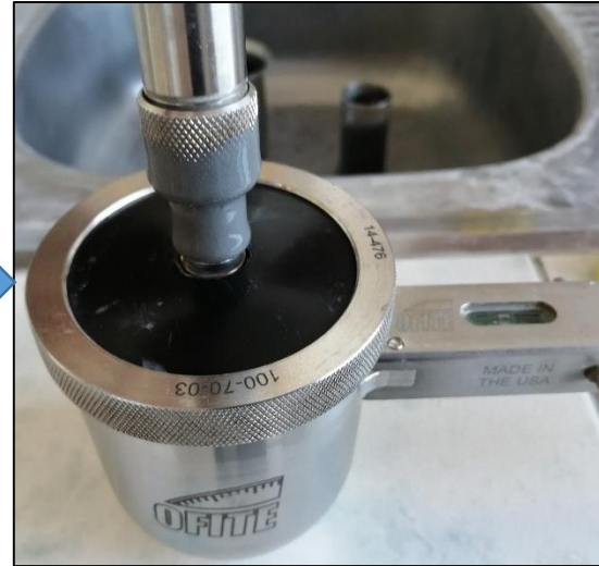
Presurización con lodo
