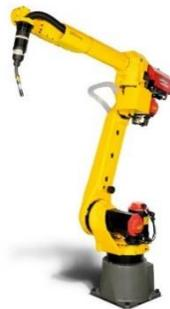
**Figura 21.** Robot Industrial Soldador
