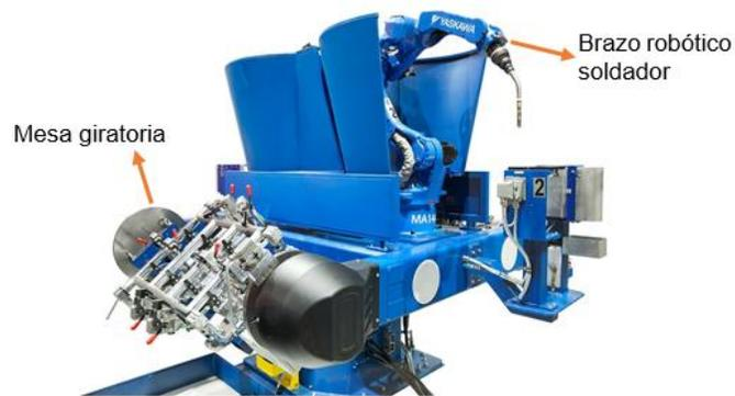
**Figura 47.** Ejemplo de dispositivos de intercambio
