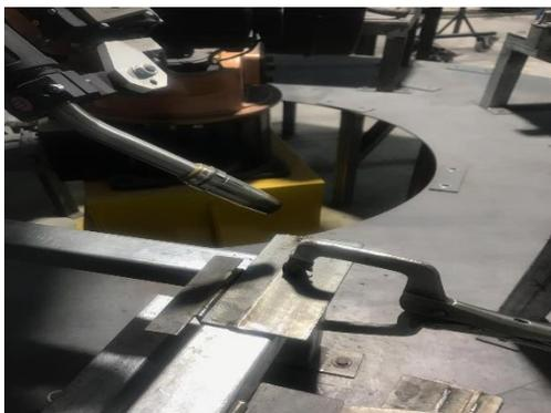
**Figura 175.** Listo para soldar unión tipo solape
