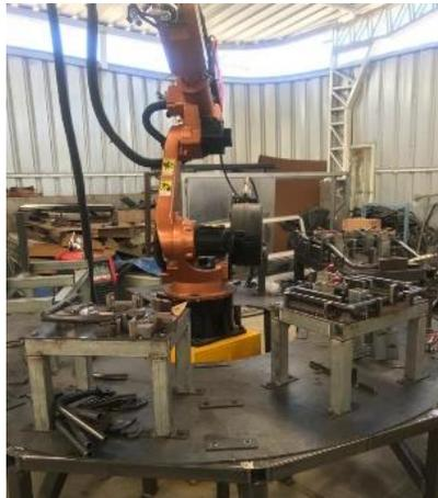
**Figura 193.** Jigs de soldadura
