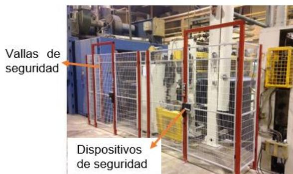
**Figura 46.** Ejemplo de vallas de seguridad
