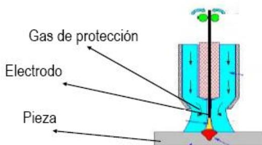
**Figura 27.** Partes soldadura MIG
