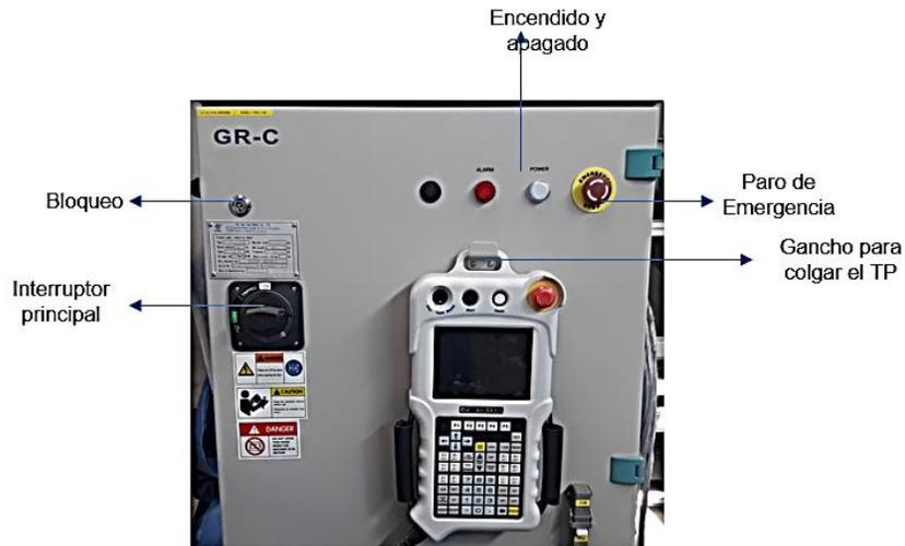
**Figura 25.** Gabinete del Controlador Robot Soldador GSK RH06
