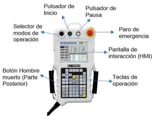
**Figura 26.** TP Robot Soldador GSK RH06
