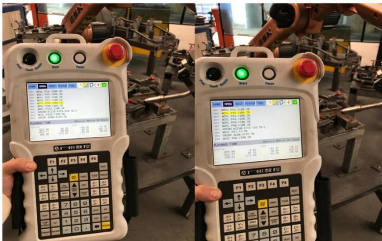
**Figura 165.** Proceso en vacío Modo Play del Jig de Codera
