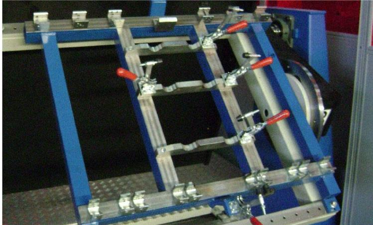
**Figura 58.** Ejemplo de Jig de soldadura móvil
