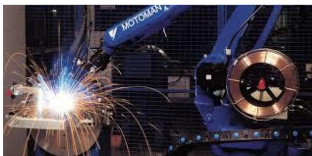
**Figura 15.** Herramienta Robot Soldador
