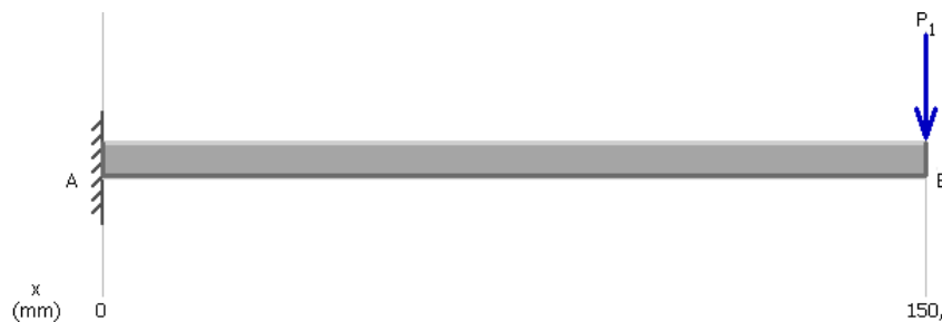
Figura 33 Fuerza aplicada al eslabón largo.
