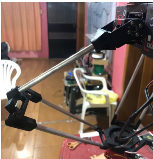
Figura 69 Acople de rótula al servomotor.
