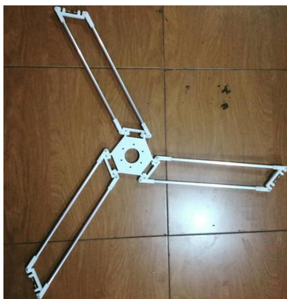
Figura 68 Ensamble de las rótulas y base móvil.
