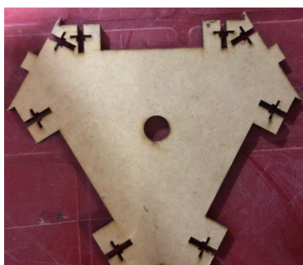
Figura 67 Corte láser de MDF de la base fija.
