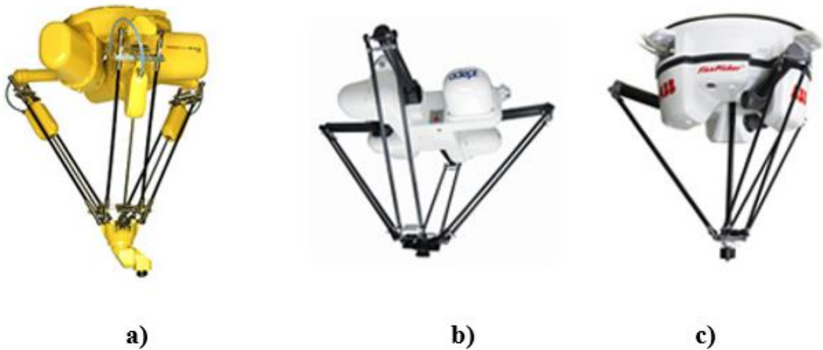
Figura 10 Ejemplos de robots paralelos a) FANUC Corporation b) Adept Technology c) ABB.
