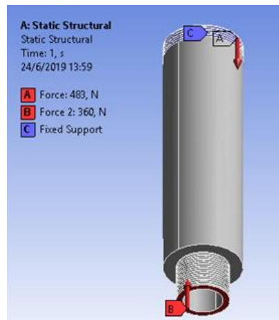
Figura 32. Análisis Estructural del cilindro de amortiguación
