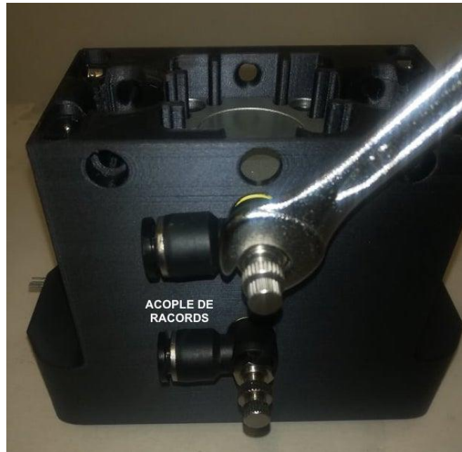
Figura 87. Acople de racords al cilindro neumático
