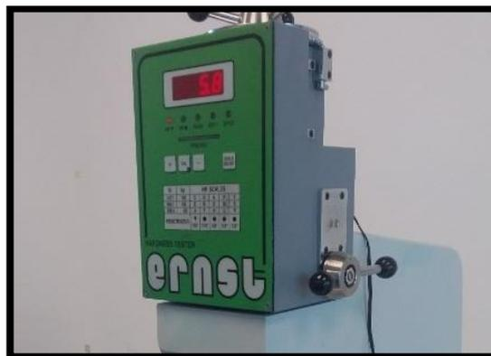
*Figura No. 86.* Panel de visualización de datos durómetro digital.
