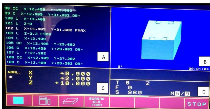
**Figura No. 147.** Simulación del mecanizado afinado de la falda.
