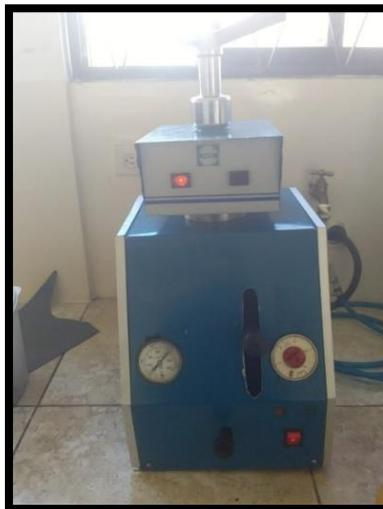
*Figura No. 62.* Prensa hidráulica para probetas metalográficas.
