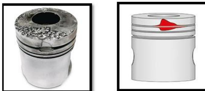
*Figura No. 38.* Daños en el segmento del pistón.
