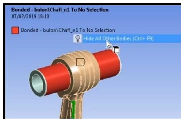
*Figura No. 108.* Superficie de contacto del bulón.
