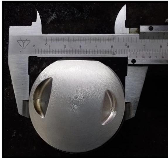
*Figura No. 47.* Medición del diámetro de cabeza del pistón.
