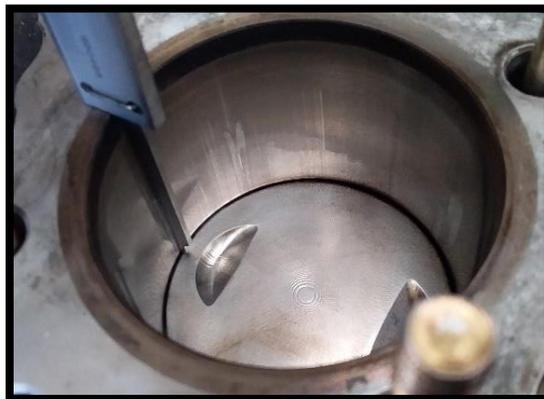
*Figura No. 48.* Medición de la carrera del pistón.
