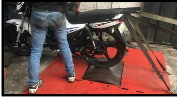
**Figura No. 87.** Anclaje de la motocicleta al dinamómetro.
