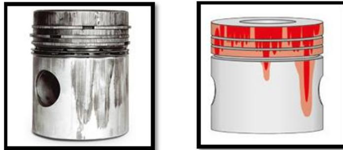
**Figura No. 34.** Daños de gripado por calentamiento.
