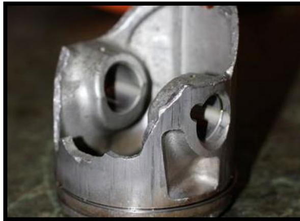
**Figura No. 11.** Pistón con ruptura en la falda.
