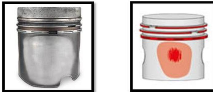
**Figura No. 39.** Desgaste radial debido a derrame de combustible.
