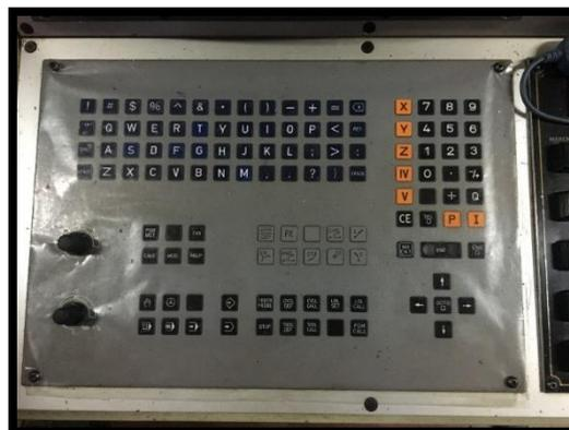
*Figura No. 149.* Teclado del controlador Anayak –Matic-7-CNC.
