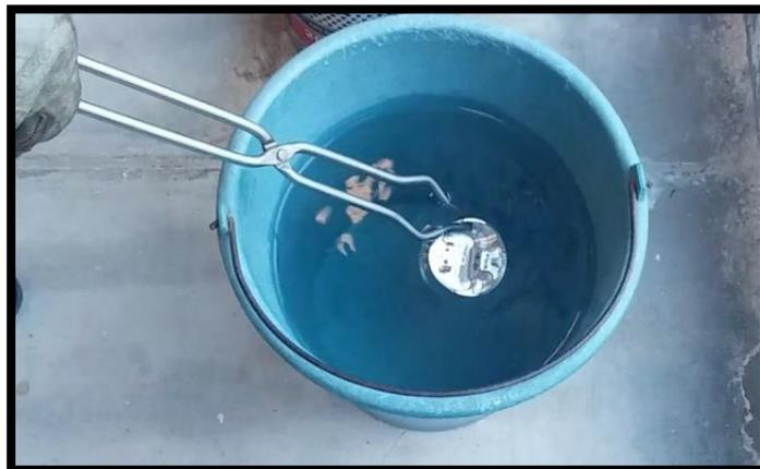
*Figura No. 152.* Templado del pistón en agua desmineralizada.
