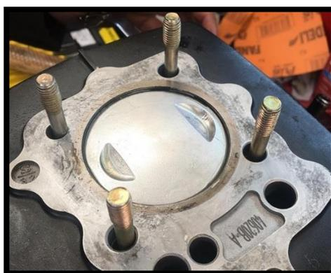
**Figura No. 162.** Pistón manufacturado montado en el motor de combustión interna de la motocicleta.
