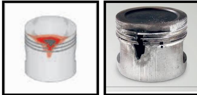
**Figura No. 35.** Fundición de la cabeza del pistón.
