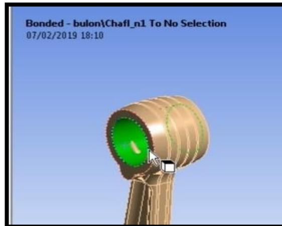
*Figura No. 109.* Superficie de contacto pie de biela.
