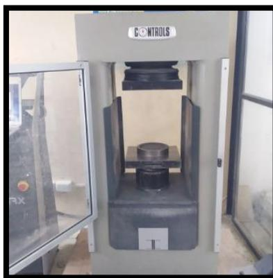
*Figura No. 73.* Máquina de ensayo de compresión marca Controls.
