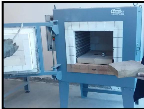
*Figura No. 153.* Horno abierto para que se produzca el enfriamiento hasta temperatura ambiente.
