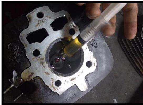
*Figura No. 46.* Medición del volumen de la cámara.
