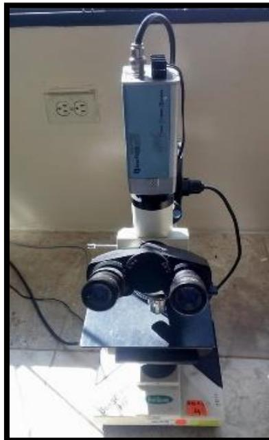
*Figura No. 67.* Microscopio metalográfico.
