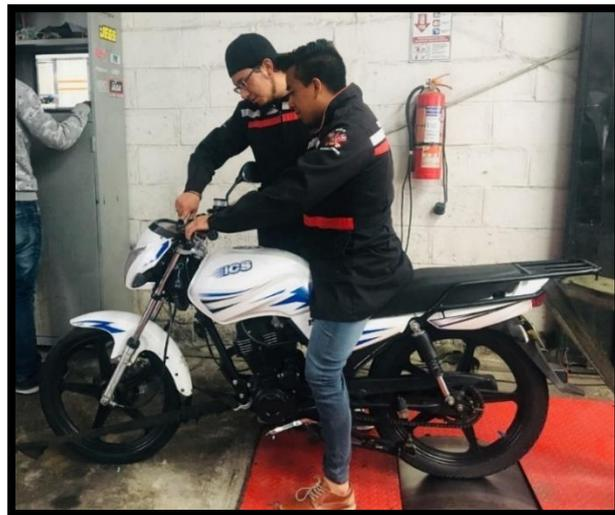
**Figura No. 88.** Prueba dinamométrica en acción.
