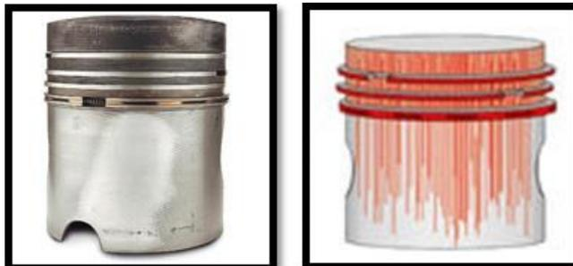
**Figura No. 40.** Desgaste axial debido a la suciedad.
