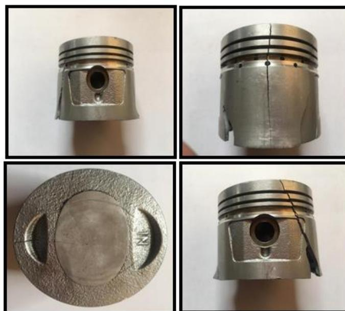
*Figura No. 78.* Resultado de la prueba de compresión.
