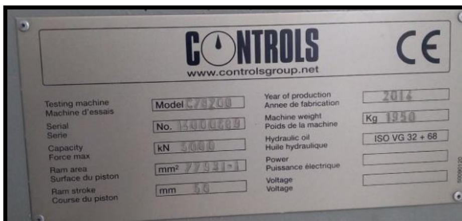
*Figura No. 74.* Placa de identificación máquina ensayo de compresión.
