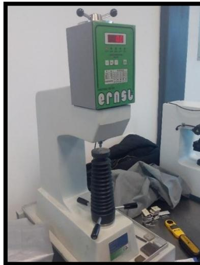
*Figura No. 85.* Durómetro digital ERNST.
