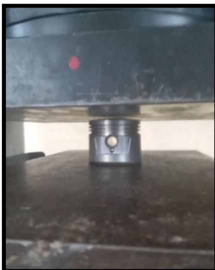
*Figura No. 75.* Colocación del pistón en las planchas de la máquina.
