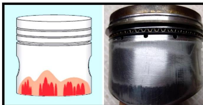
*Figura No. 165.* Reconocimiento de falla de gripado en la falda del pistón.
