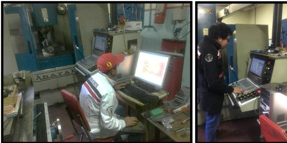
*Figura No. 141.* Generación y verificación de código GUI en el software CAM y en la máquina CNC.
