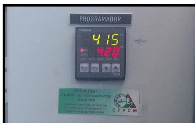
*Figura No. 82.* Parámetros del proceso de templado en el programador.
