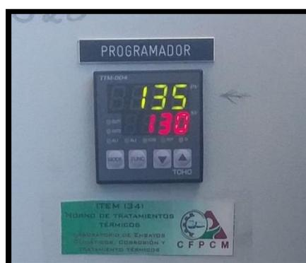
*Figura No. 84.* Parámetros del proceso de envejecido en el programador.
