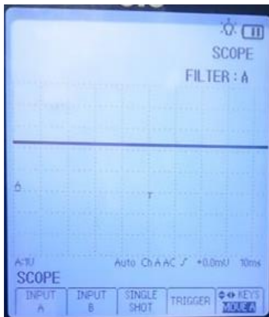
Figura 76. Oscilograma del sensor IAT a 32°C con el osciloscopio OTC
