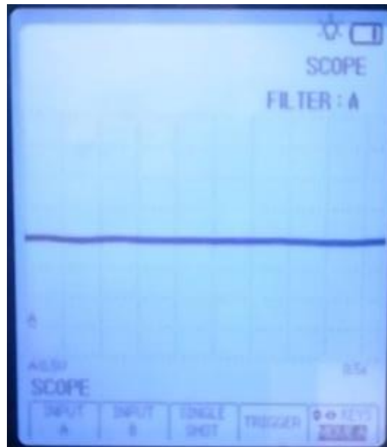
Figura 84. Oscilograma del sensor FRP a ralentí con el osciloscopio OTC
