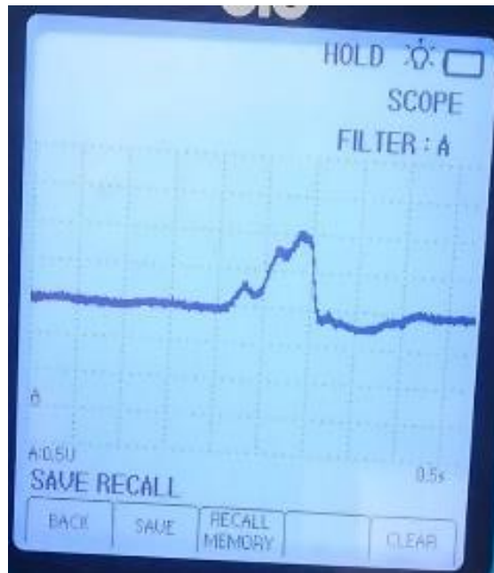
Figura 86. Oscilograma del sensor FRP a 1500rpm con el osciloscopio OTC
