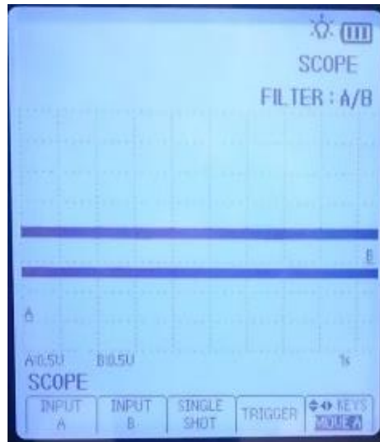
Figura 58. Oscilograma del sensor APP a ralentí con el osciloscopio OTC
