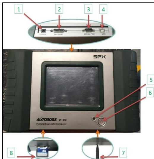
Figura 54. Partes del escáner Autoboss V-30
