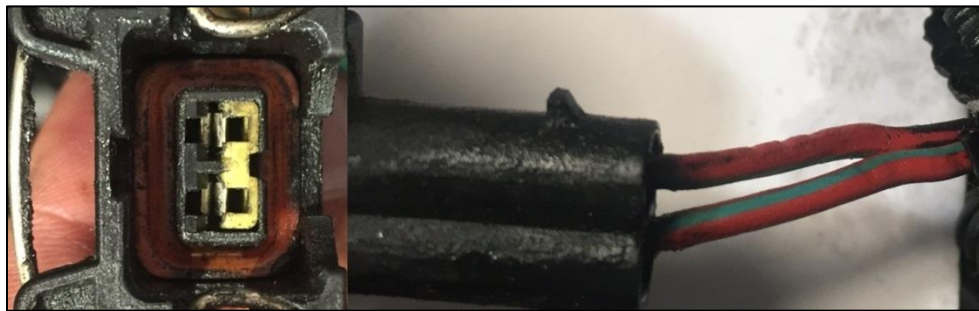
Figura 93. Colores de cables y socket del sensor FTS
