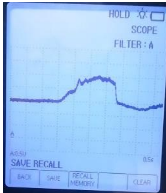
Figura 88. Oscilograma del sensor FRP a 2500rpm con el osciloscopio OTC
