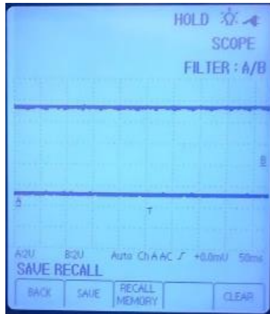
Figura 120. Oscilograma del sensor ECT a 90°C con el osciloscopio OTC
