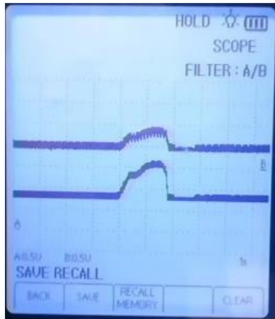
Figura 62. Oscilograma del sensor APP a 2500rpm con el osciloscopio OTC
