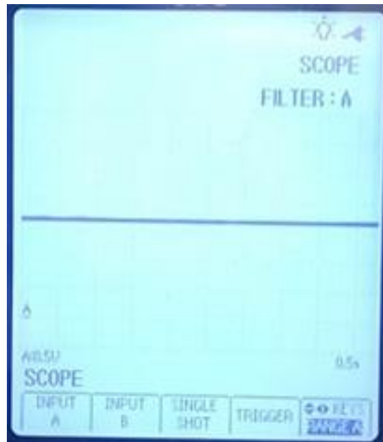
Figura 95. Oscilograma del sensor FTS a 17°C con el osciloscopio OTC
