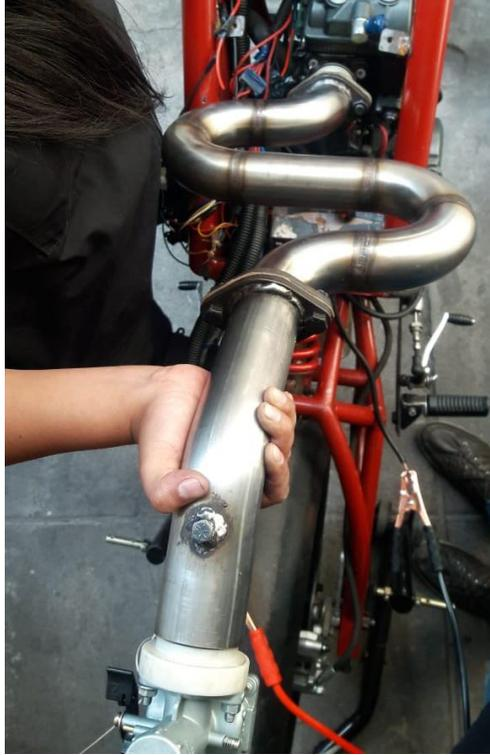
**Figura 58.** *Ensamble del Colector Curvo Largo*
