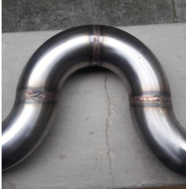
**Figura 43.** Unión por suelda tipo TIG
