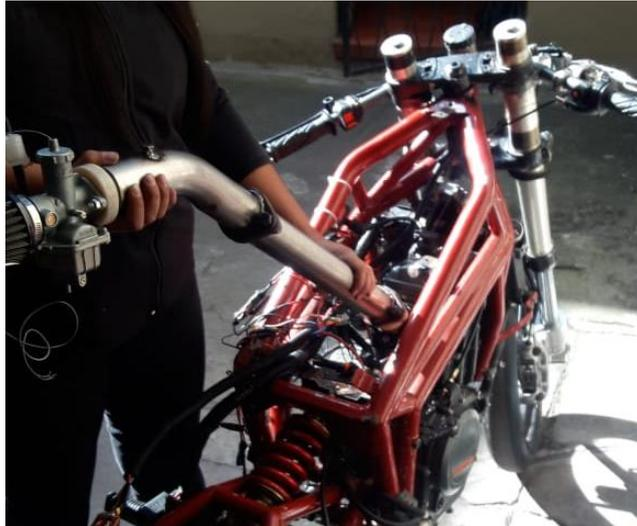
*Figura 56. Ensamble del Colector Recto Largo*
