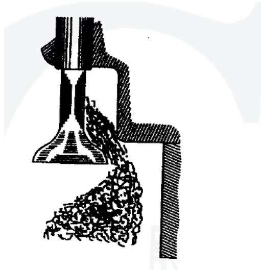
**Figura 10.** Admisión del flujo turbulento de la mezcla
