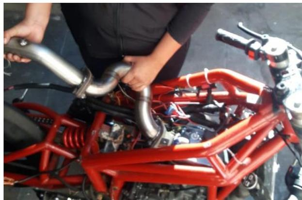
*Figura 57. Ensamble del Colector Corto Curvo*
