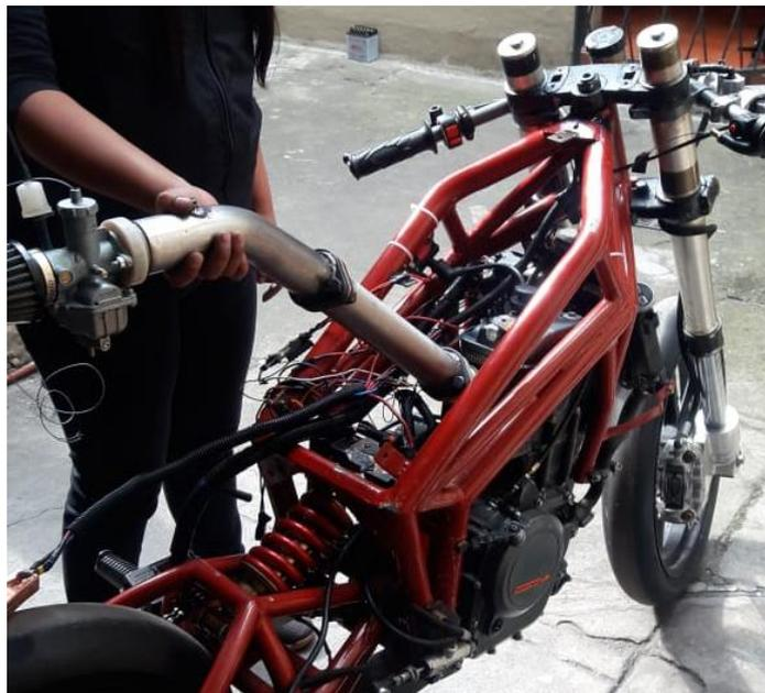
*Figura 55. Ensamble del Colector Recto Corto*
