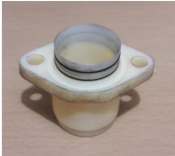
**Figura 53.** Acople entre el motor y el conducto de admisión
