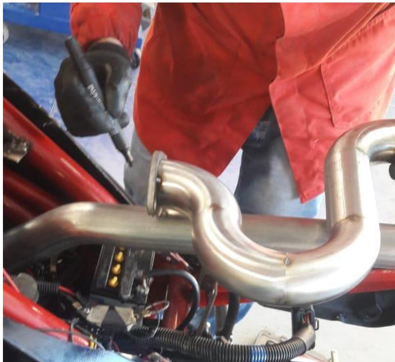
**Figura 46.** Medición requerida para la conexión del motor
