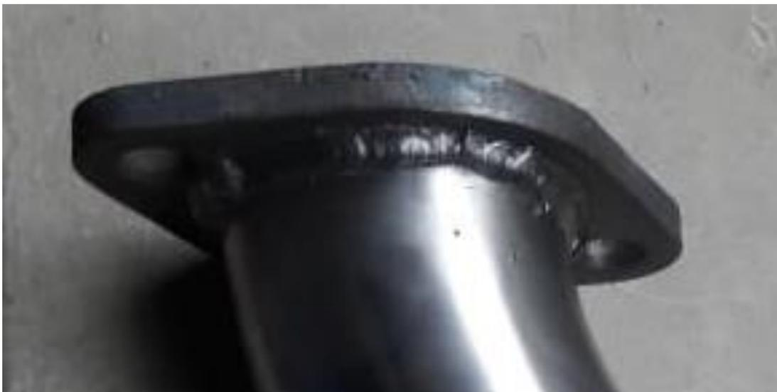
**Figura 44.** Suelda MIG para la unión de las bridas
