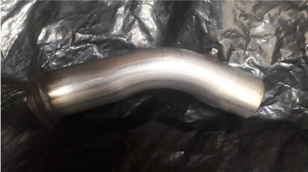
**Figura 47.** *Colector de conexión entre el carburador y los colectores.*
