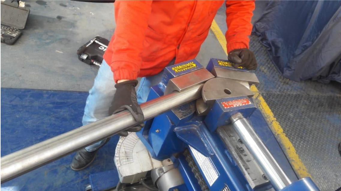
**Figura 45.** Dobladora de tubos dando forma a la conexión del carburador
