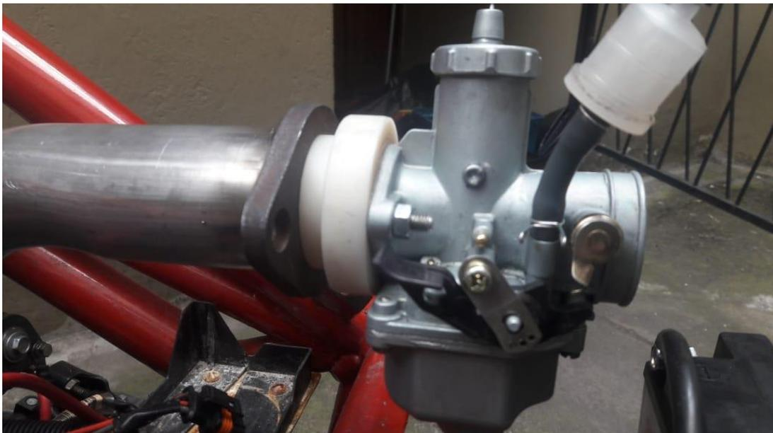
**Figura 52.** Montaje de conexión entre el colector y el carburador
