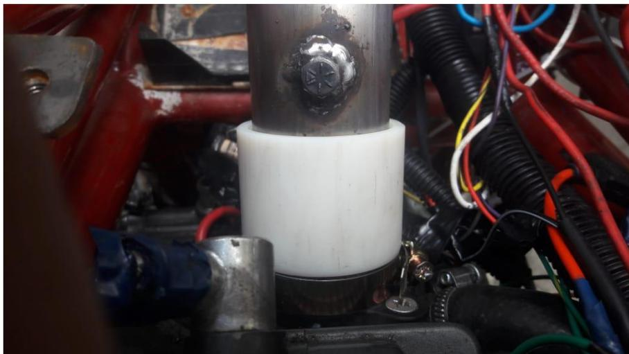
**Figura 54.** Montaje entre el colector de admisión y el motor
