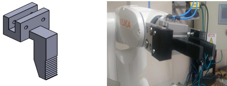
Figura 35. Gripper Diseñado en SOLIDWORKS para Objetos Metalúrgicos.
