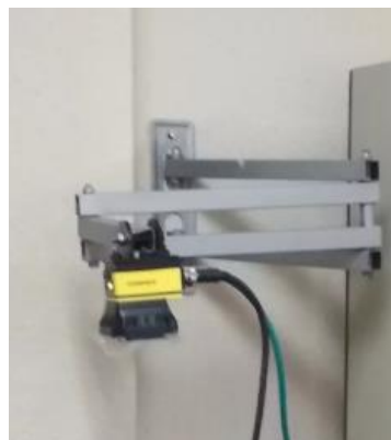
Figura 27. Soporte Horizontal para Manejo Manual de Cámara In-Sight 7600
