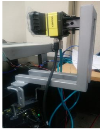
Figura 26. Soporte Vertical para Manejo Manual de Cámara In-Sight 7600
