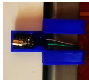
Figura 32. Soporte 1 Módulo Láser KY-008
