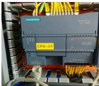
Figura 17. Partes externas del PLC S7-1200
