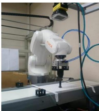
Figura 52. Calibración de Herramienta y Ejes del Robot KUKA KR3 R540 (DERECHA) – Colocación de Objetos en Caja con Compartamientos (Izquierda)
