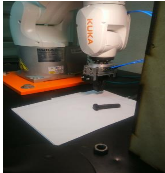
Figura 54. Robot KUKA KR3 R540 y objeto metalúrgico detectado.
