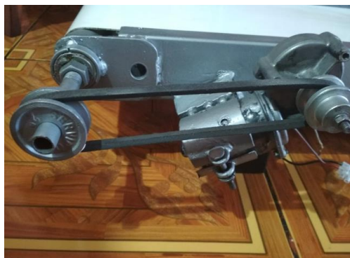
Figura 29. Motor de 12 VDC para Banda Transportadora
