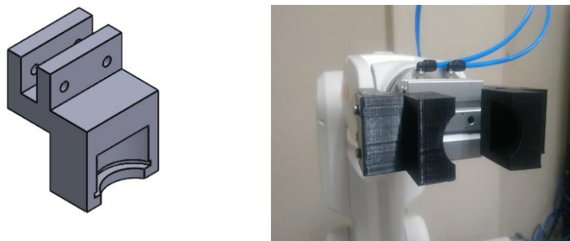
Figura 36. Gripper Diseñado en SOLIDWORKS para Bebidas Embotelladas.
