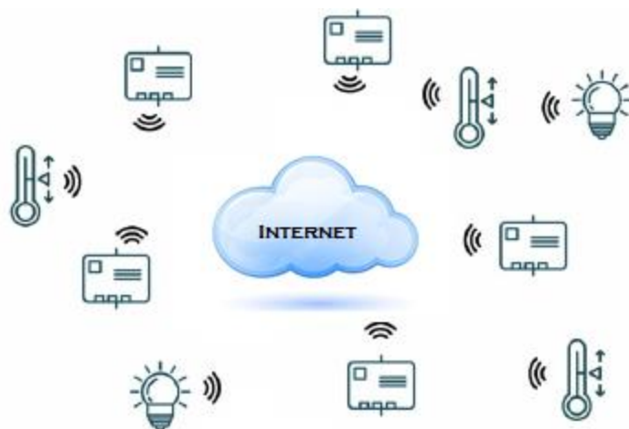
Figura 9. Arquitectura para conexión de sensores directamente a Internet (centralizada) Modificado de: (Otri, 2016)
