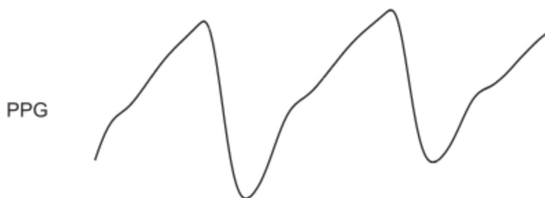
Figura 1. El componente pulsátil (AC) de la señal de PPG
