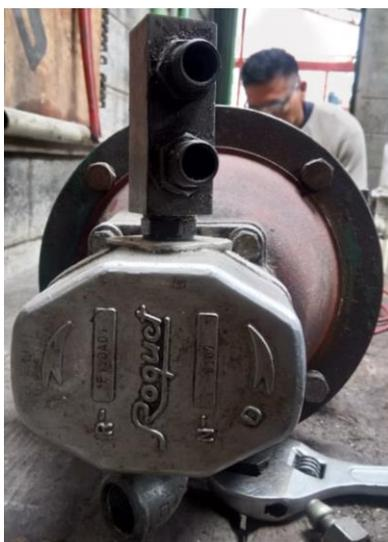
*Figura 172* Bomba de engranajes Rocket.
