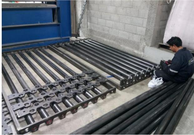
**Figura 163** Ensamblado de todos los componentes de las bandejas moldeadoras dobles.
