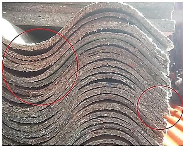
**Figura 7** Variación en espesores y forma de onda de cubiertas P7.
