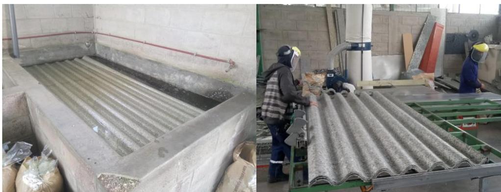
**Figura 19** a) Remojo de cubiertas para la extracción de la lámina de teflón b) Corte de las cubiertas con las medias estandarizadas bajo INEN 1320 y NTC 160.
