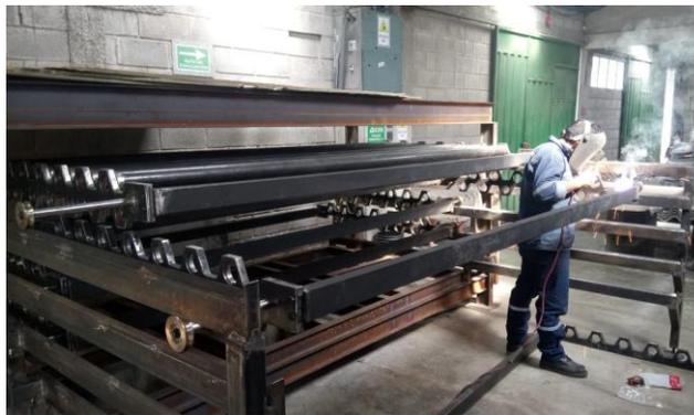
**Figura 170** Soldado de ejes en bandejas moldeadoras.
