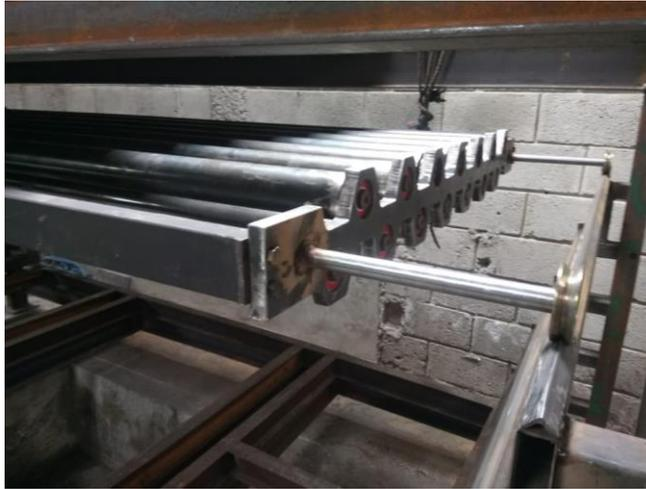
**Figura 169** Verificación de asentamiento de bandejas en el sistema de rieles.
