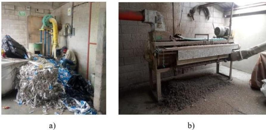
**Figura 14** a) Desagregación del Tetra Pak, b) Separación de cartón del Polialuminio en la máquina centrífuga.
