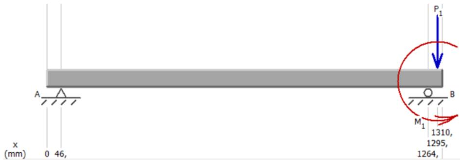
**Figura 129** DCL eje transmisor de torque en el eje X-Z
