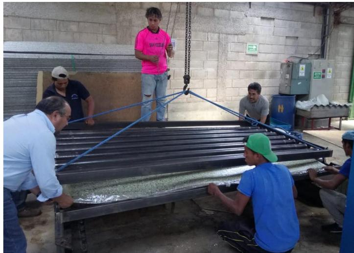
**Figura 160** Prueba de funcionamiento con la bandeja superior e inferior del sistema de bandejas moldeadoras.
