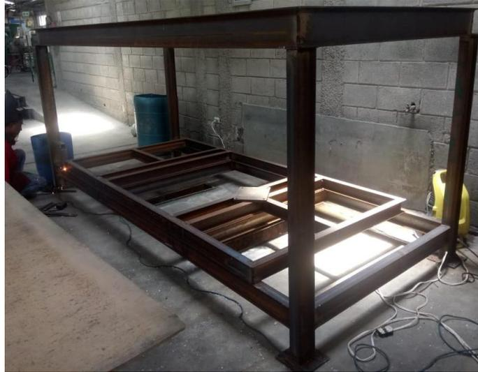
**Figura 162** Bastidor de la prensa en proceso de soldadura SMAW.
