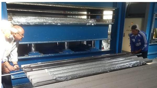
**Figura 18** Conformado manual de las cubiertas onduladas de Polialuminio.
