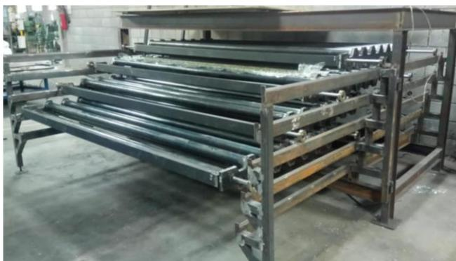
*Figura 171* Ensamblaje completo del sistema de rieles y bandejas moldeadoras.
