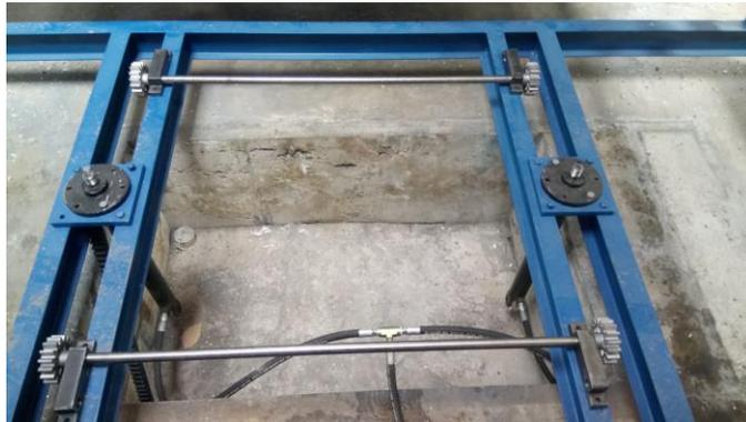
*Figura 179* Ensamblaje de piñones y ejes de transmisión.
