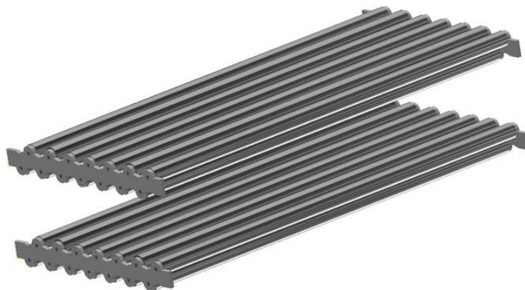
**Figura 31** Vista isométrica del sistema de bandejas de la segunda propuesta.
