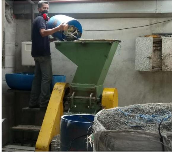
**Figura 15** Colocación del polialuminio en la trituradora previamente extraído de la máquina centrifugadora.
