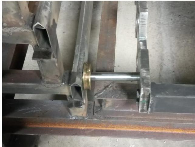
*Figura 168* Longitud del eje no coincide con la separación del riel.
