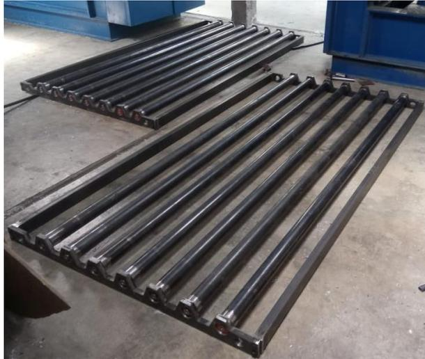
**Figura 159** Ensamblaje de bandejas simples para pruebas de conformado
