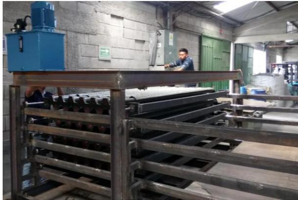
*Figura 177* Sistema hidráulico acoplado al bastidor de la prensa moldeadora.
