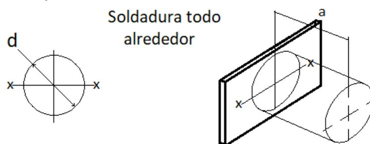
**Figura 81** Factor geométrico para analizar la soldadura como una línea en un eje en voladizo.
