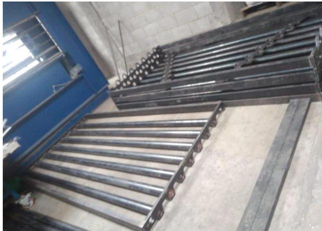
**Figura 164** Ensamblaje de bandejas simples para pruebas de conformado
