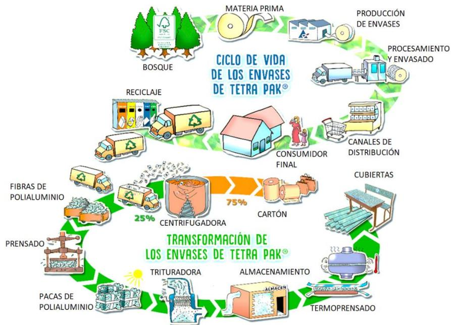
**Figura 12** Proceso de transformación del Tetra Pak
