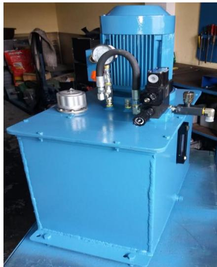
*Figura 176* Sistema hidráulico con todos sus componentes.
