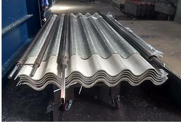
**Figura 2** Proceso manual de conformado de cubiertas P7.
