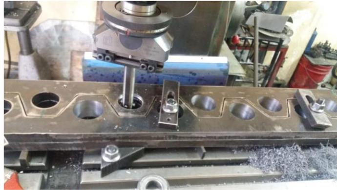
*Figura 155* Placas en proceso de maquinado.
