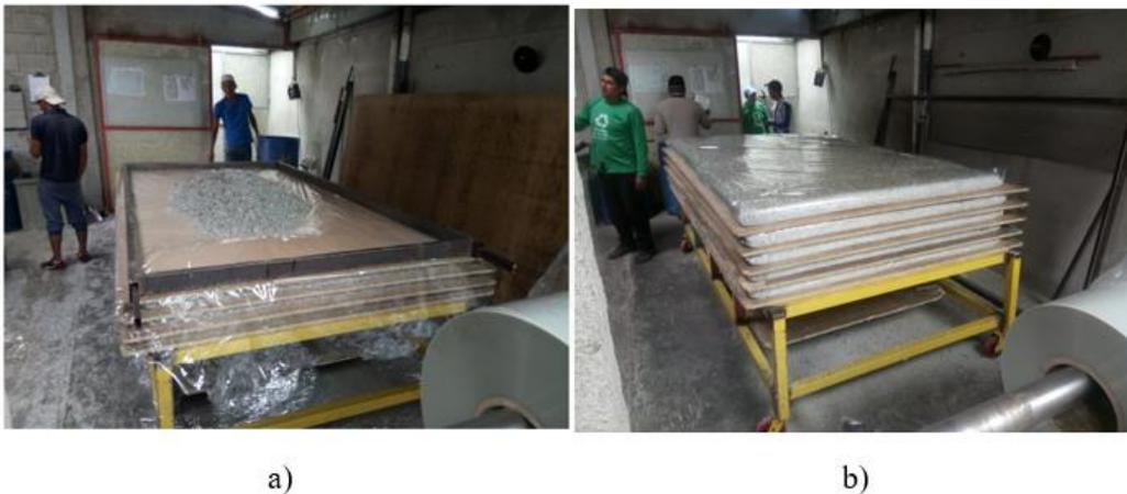
**Figura 16** a) Proceso de moldeo de planchas, b) Moldes listos para ser colocados en la termoprensa.
