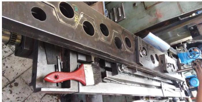
*Figura 154* Placas de soporte de bandejas después del proceso de corte por plasma listas para ser maquinadas.
