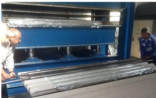
**Figura 5** Conformado manual de cubiertas.
