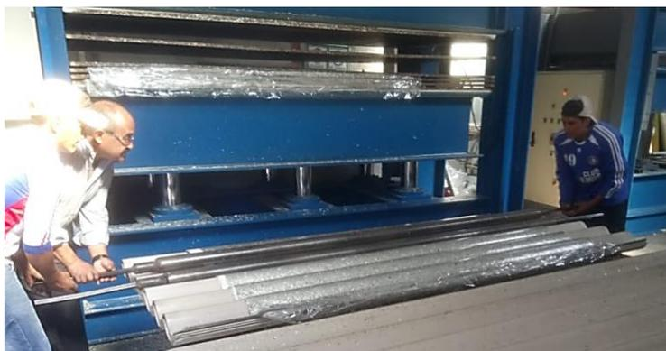
**Figura 22** Conformado manual de cubiertas.
