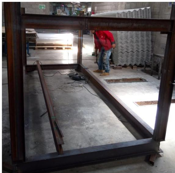
**Figura 161** Bastidor en posición invertida debido al proceso de soldado de vigas inferiores.
