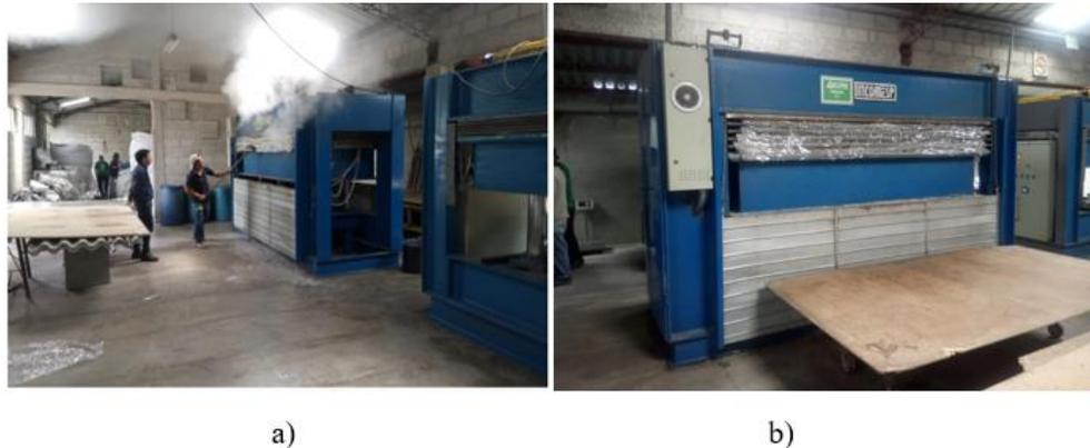
**Figura 17** a) Proceso de moldeo de planchas, b) Moldes listos para ser colocados en la termoprensa.
