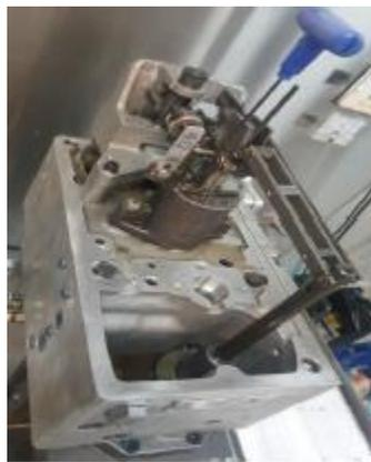
**Figura 21.** Calibración de gobernador después de overhaul
