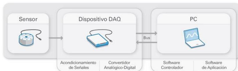
**Figura 24.** Partes de un Sistema DAQ
