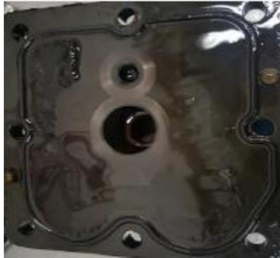
**Figura 18.** Desgaste en base de bomba de aceite
