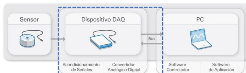
**Figura 25.** Partes de la tarjeta de adquisición de datos
