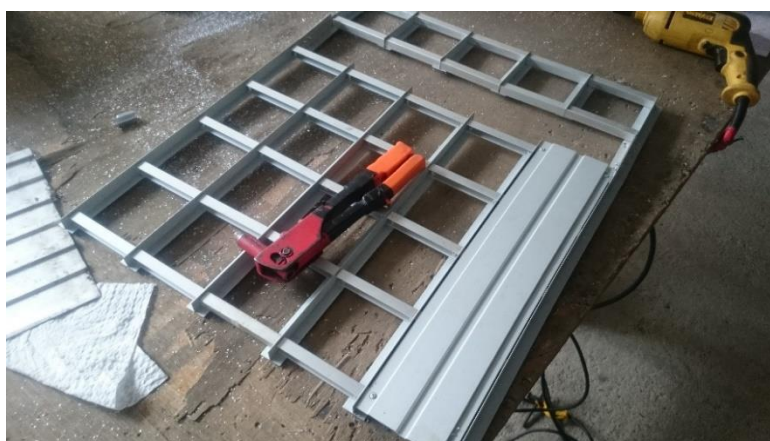
Figura 102. Mallado de acero Aluminio 6063
