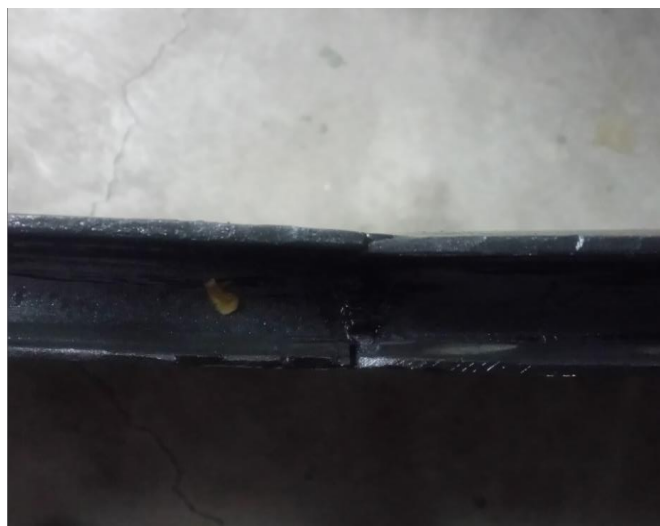
Figura 117. Falla longitudinal Prototipo A36
