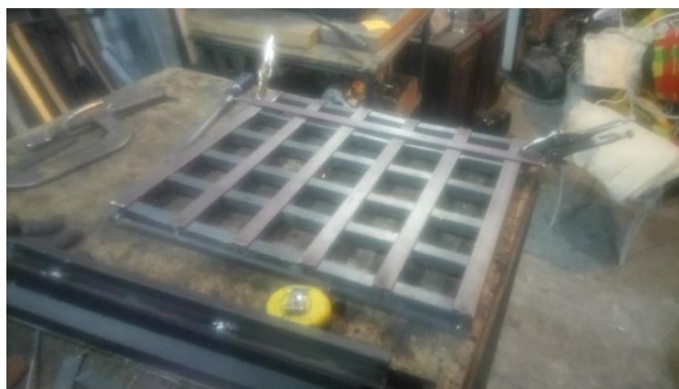
Figura 104. Mallado de acero A36
