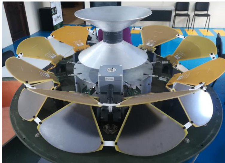
Figura 19 Arreglo de 9 antenas direccionales.
