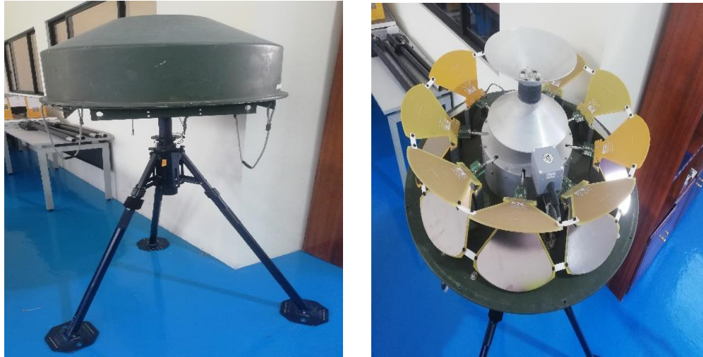
Figura 26 Arreglo de Antenas circulares TCI.
