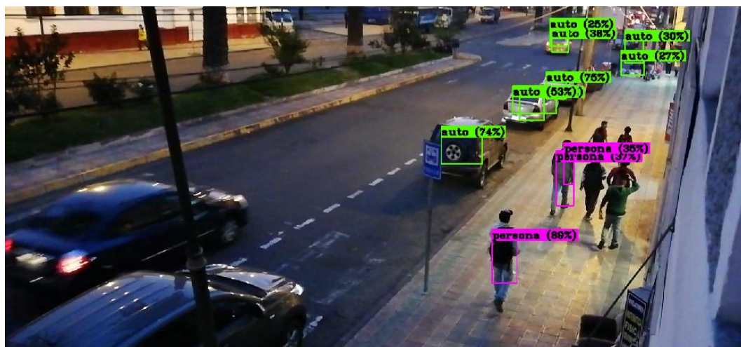
Figura 50. Detección de sistema autónomo, video capturado entiempro real. Fuente: Sistema autónomo de detección.
