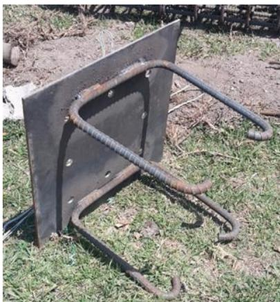
**Figura 34.** Empotramiento de placa en columnas de hormigón
