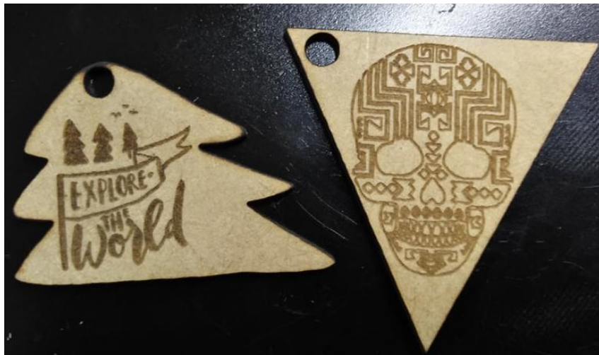
Figura 60. Corte y grabado complejo en madera MDF de 3 mm
