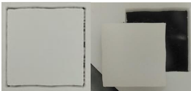
Figura 57. Cortes realizados en acrílico blanco de 3 mm
