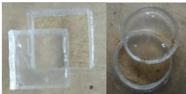
Figura 58. Cortes realizados en acrílico transparente de 4 mm
