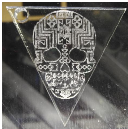
Figura 61. Corte y grabado complejo en acrílico transparente de 4 mm
