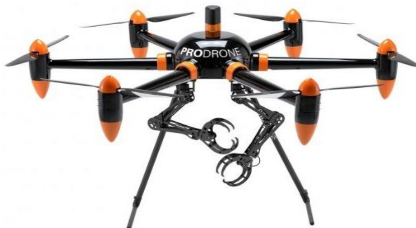
Figura 15. Robot aéreo controlado para la detección y detonación de minas personales Fuente: (Torrente Digital, 2016)
