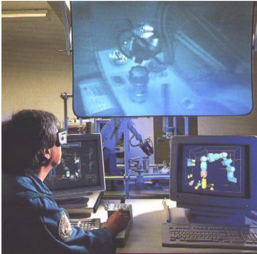
Figura 13. Primer sistema telerobótico enviado al espacio, ROTEX Fuente: (Artigas et al, 2012)
