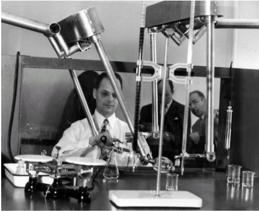
Figura 11. Sistema teleoperado desarrollado por Raymond Goertz, que permite la manipulación de materiales radioactivos
