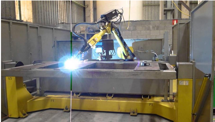
Figura 9. Proceso de soldadura TIG realizado por un brazo robótico Fuente: (Serecon, 2016)
