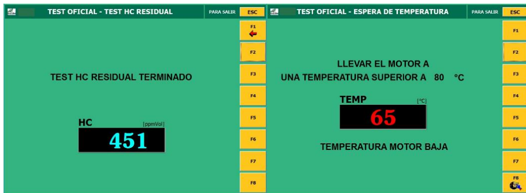
Figura 49. Test de HC Residual y prueba de temperatura
