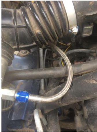
Figura 23. Cañería de ventilación
