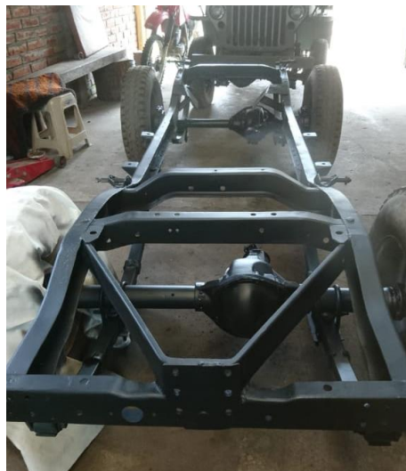
Figura 35. Chasis correctamente preparado
