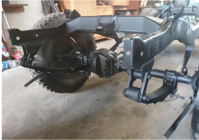
Figura 26. Diferencial delantero original Willys 1952
