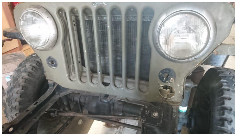
Figura 75. Instalación de los faros delanteros
