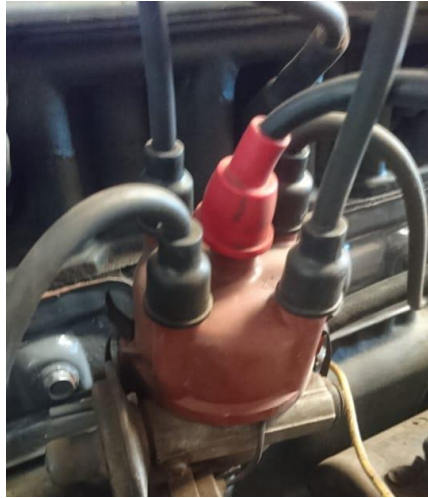
Figura 82. Distribuidor reparado y cables de bujías nuevos
