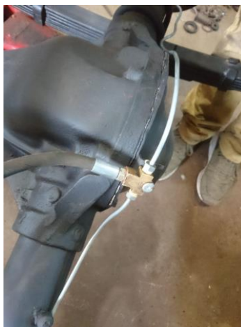
Figura 68. Colocación de tuberías del líquido de frenos
