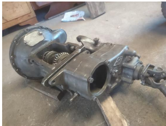
Figura 24. Caja de transferencia original Willys 1952
