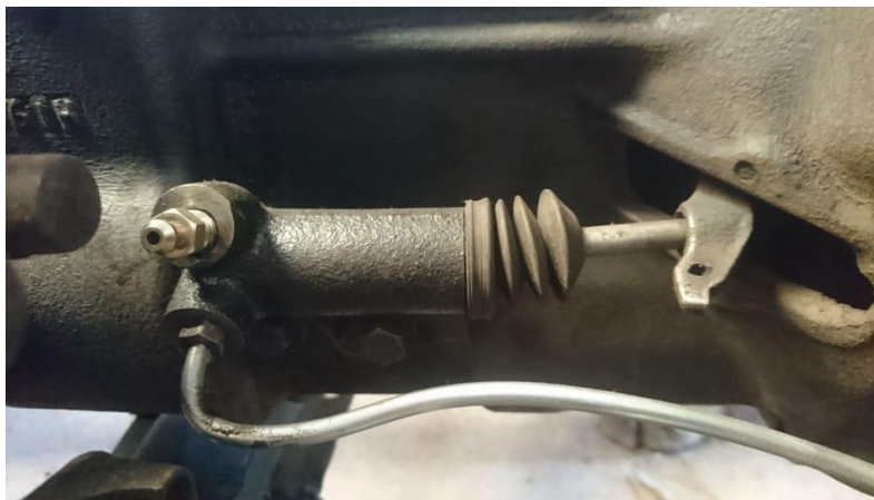
Figura 71. Instalación de la bomba del accionamiento del embrague
