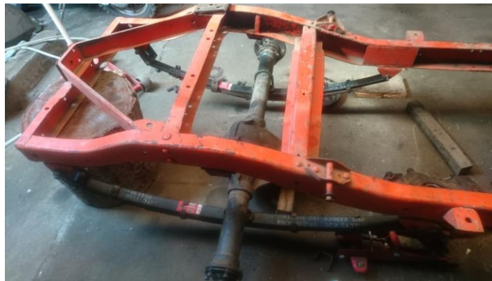
Figura 39. Chasis con el paquete de ballestas y diferencial colocado
