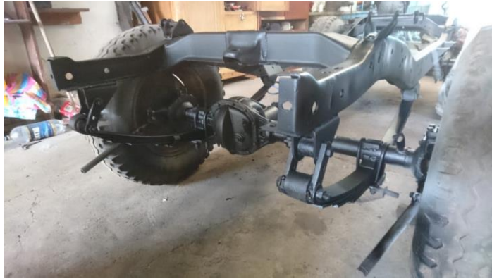
Figura 40. Diferencial delantero unido a la suspensión
