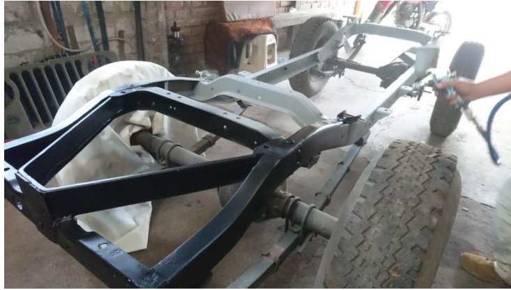
Figura 34. Aplicación de pintura
