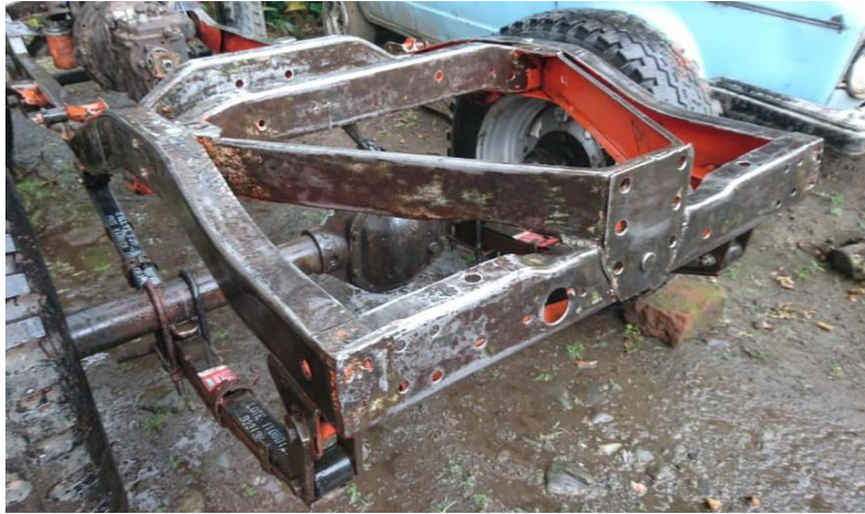
Figura 32. Pulida a fondo y limpieza del óxido
