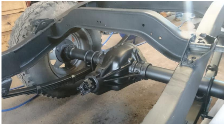
Figura 41. Diferencial trasero unido a la suspensión
