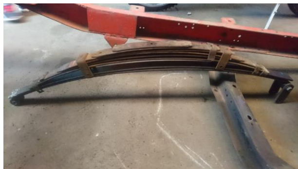
Figura 37. Paquete de ballestas restaurado
