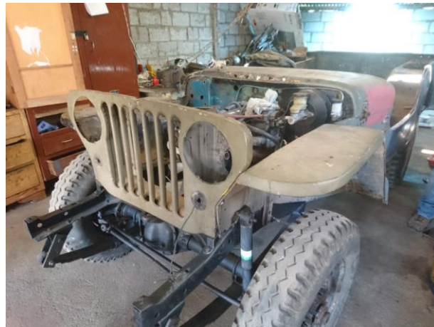
Figura 89. Colocación de guardabarras
