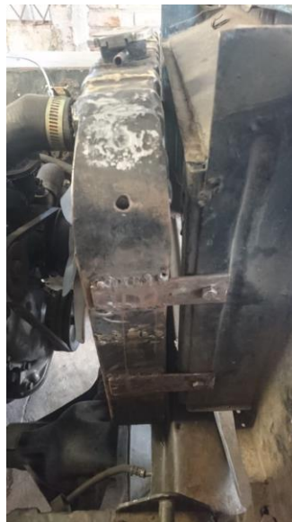
Figura 58. Segunda base para el radiador
