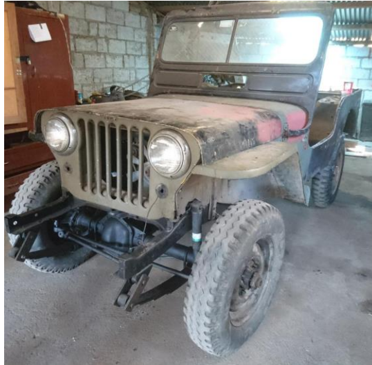
Figura 92. Colocación del parabrisas y preparación para la pintura
