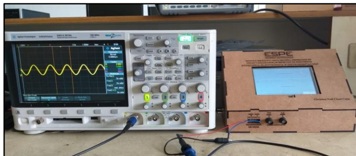
Figura 58. Conexión entre el generador del módulo y el equipo Agilent DSO-X 2014 a
