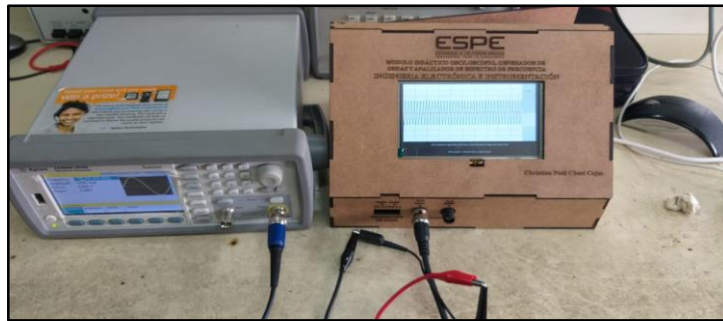
Figura 59. Conexión entre el generador Agilent 33500B y el osciloscopio del módulo
