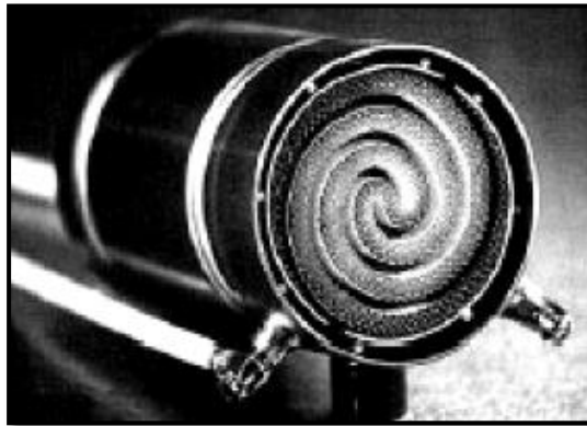
Figura 4. Monolito metálico enrollado.
