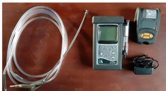
*Figura 11.* Analizador de gases portátil KANE 4-2 plus
