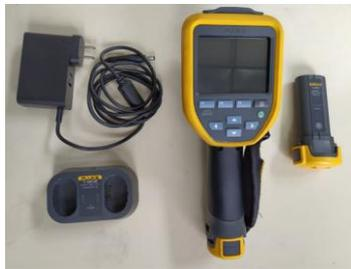
**Figura 19.** Cámara termográfica FLUKE TI SBC3B
