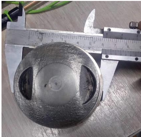
Figura 19. Medición del diámetro de cabeza del pistón
