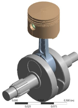
Figura 64. Mecanismo biela manivela
