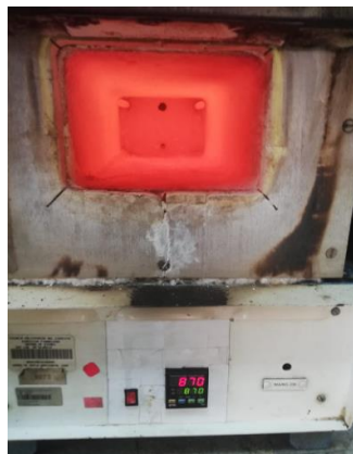
Figura 55. Temperatura ideal para austenizar el acero.
