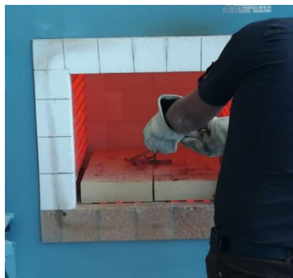
Figura 96. Biela dentro del horno a 200°C
