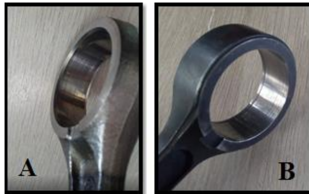
Figura 108. A. Estado de la cabeza de biela de fábrica, B: Estado de la cabeza de biela en acero AISI4140
