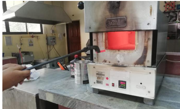
Figura 56. Probeta de acero AISI 4140 sometida a 750°C
