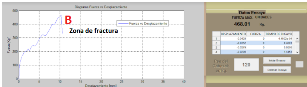
Figura 41. Zona de fractura del acero de la biela de fábrica
