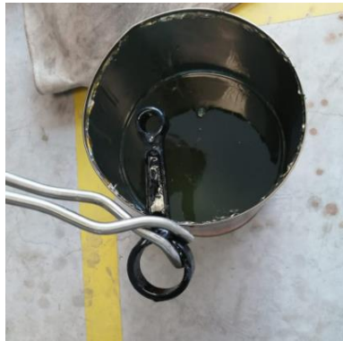
Figura 95. Templado de la biela en lubricante.
