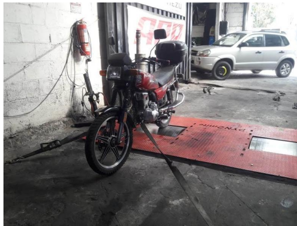
Figura 98. Anclaje de la motocicleta Shineray XY al dinamómetro
