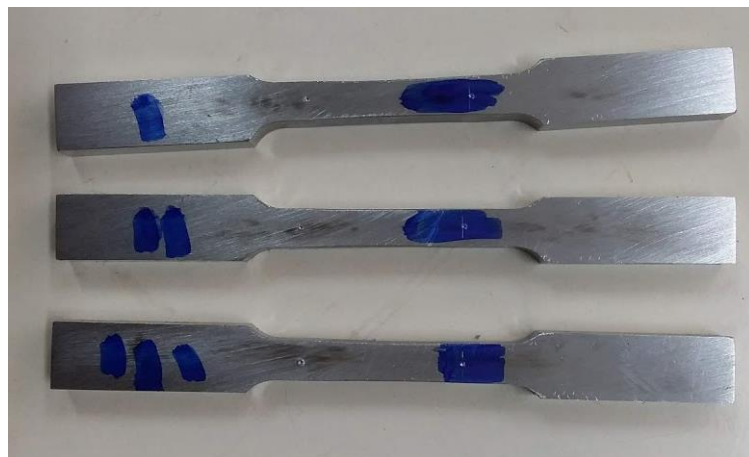
Figura 49. Probetas para ensayo de tracción en acero AISI 4140
