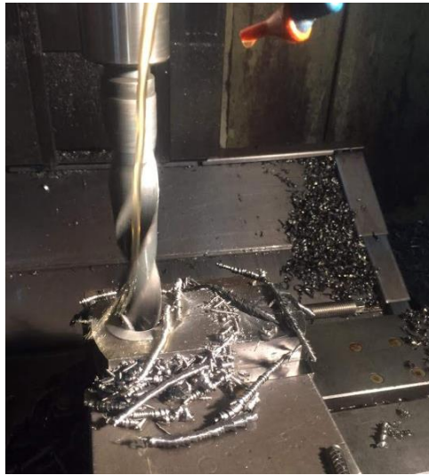
Figura 91. Proceso de mecanizado del taladrado del orificio de la cabeza de la biela
