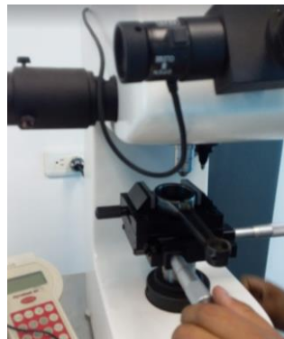
Figura 34. Ensayo de dureza en la biela de fábrica
