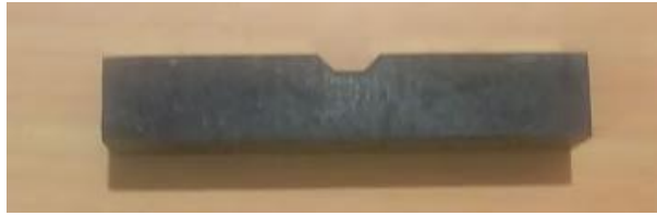
Figura 58. Probeta tratada térmicamente
