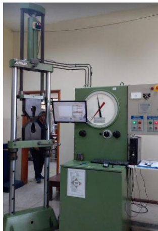
Figura 50. Máquina para ensayos de tracción AMSLER MRM-29
