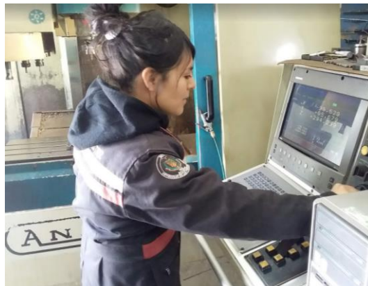
Figura 92. Mandos manuales del controlador Anayak –Matic-7-CNC.
