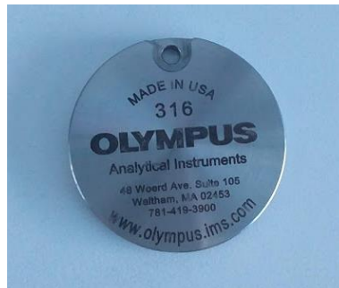
Figura 43. Patrón de calibración. Acero Inoxidable 316 OLYMPUS
