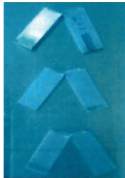
Figura 33. Probetas después del ensayo de impacto
