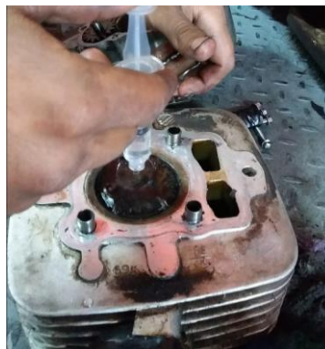
Figura 18. Medición del volumen de la cámara de combustión
