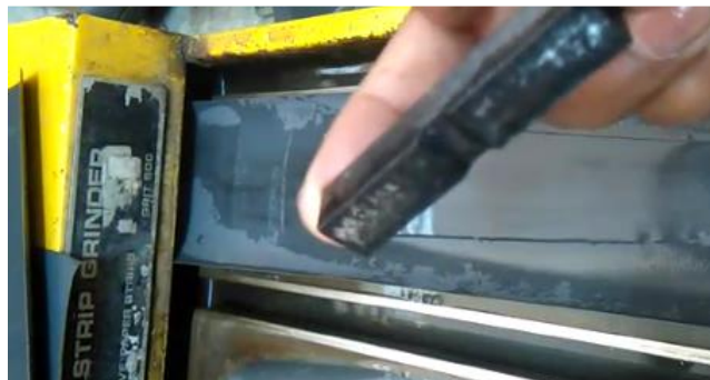
Figura 59. Preparación de la probeta de acero AISI 4140.
