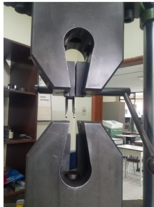
Figura 39. Ubicación de la probeta en la máquina ASMLER MRM-29
