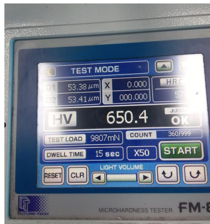
Figura 36. Resultado de la tercera medición en la biela de fábrica
