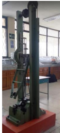
Figura 47. Máquina Charpy para ensayos de impacto de materiales metálicos.
