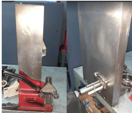
Figura 110. Máquina de comprobación de brazos de biela marca Sunnen
