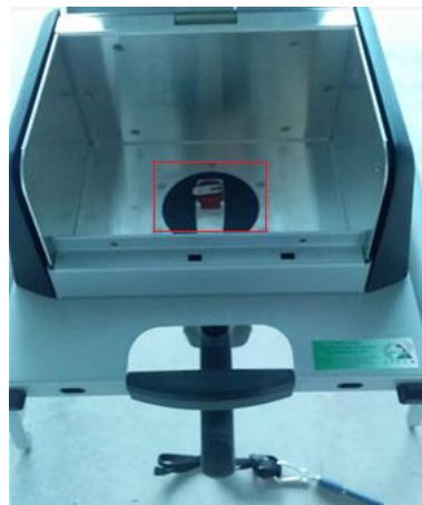
Figura 44. Material base a ensayar en el espectrómetro Olympus DPO2000-C Serie: 541828
