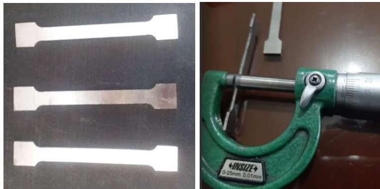
Figura 38. Probetas para ensayo de tracción obtenidas del cuerpo de la biela de fábrica
