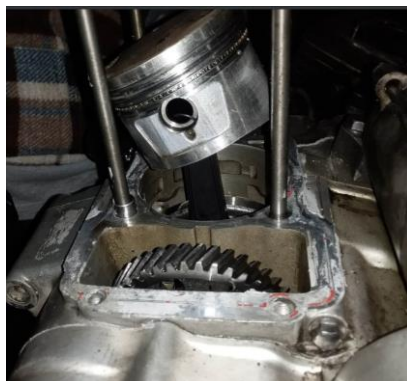
Figura 104. Biela manufacturada montada en el motor de combustión interna de la motocicleta Shineray XY 150cc.
