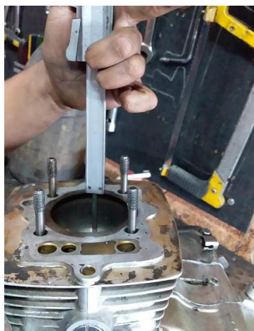
Figura 20. Medición de la carrera del pistón.
