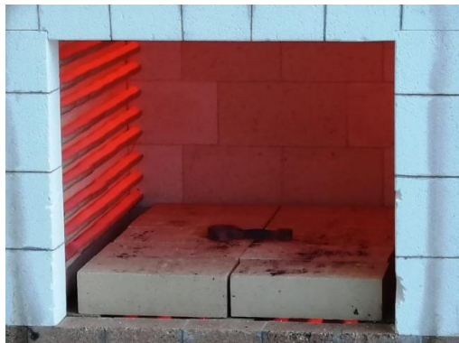
Figura 94. Biela dentro del horno a temperatura ambiente.
