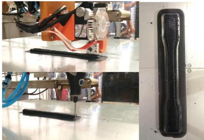
**Figura 90.** Manufactura híbrida de probeta tipo I
