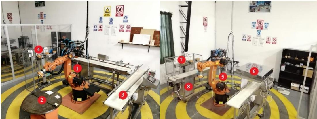
**Figura 9.** Celda de manufactura y paletizado | Celda de control de calidad y paletizado
