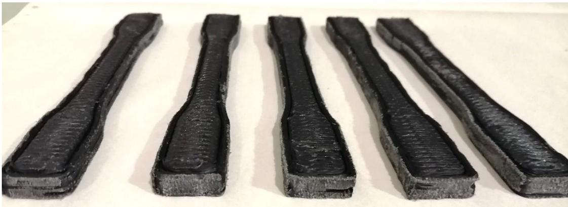
**Figura 92.** Probetas realizadas en dirección XY con sobre-extrusión y fresado
