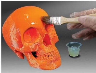
**Figura 12.** Pieza con capa de resina epoxi
