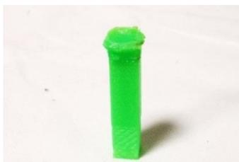
*Figura 11.* Figura con sobre-extrusión
