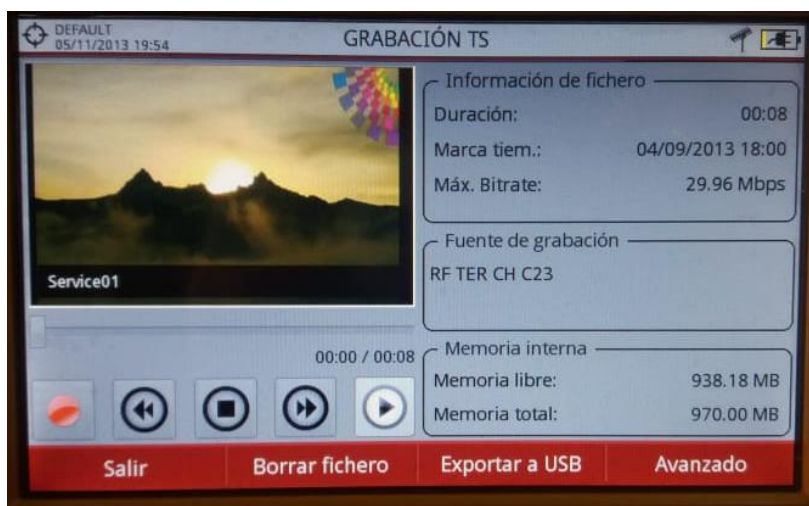
Figura 15. Grabación de TS con Ranger NEO 2
