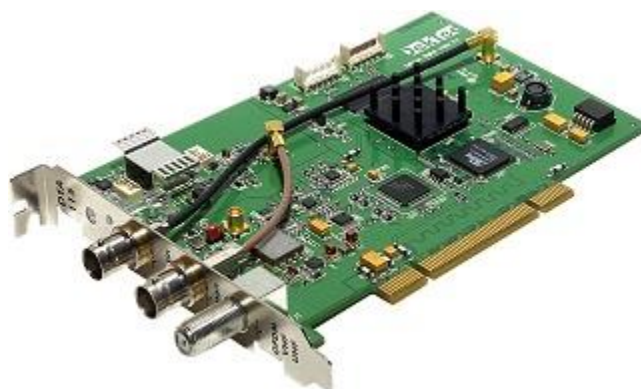
Figura 11. Tarjeta moduladora DTA-115. Fuente: Dektec.com
