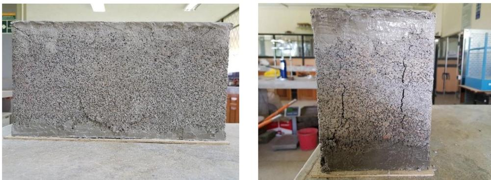
*Figura 134.* Plano de falla del bloque fabricado con arena y 30% de PP.
