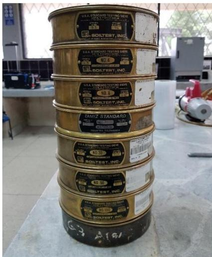
*Figura 20.* Tamices para granulometría de árido fino
