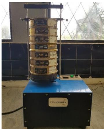
*Figura 21.* Agitador de tamices mecánico
