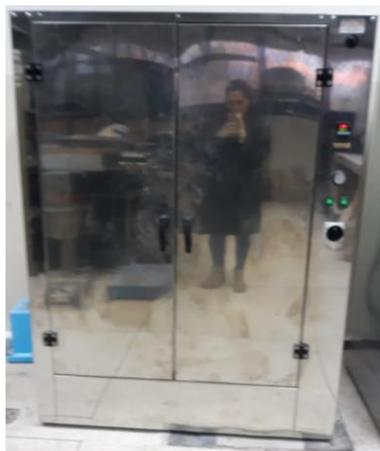
*Figura 28.* Horno del laboratorio de suelos de la Universidad de las Fuerzas Armadas ESPE
