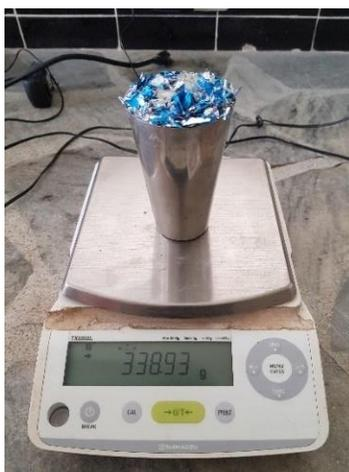
Figura 37. Registro del peso de la muestra del PP en el vaso metálico incluida el agua
