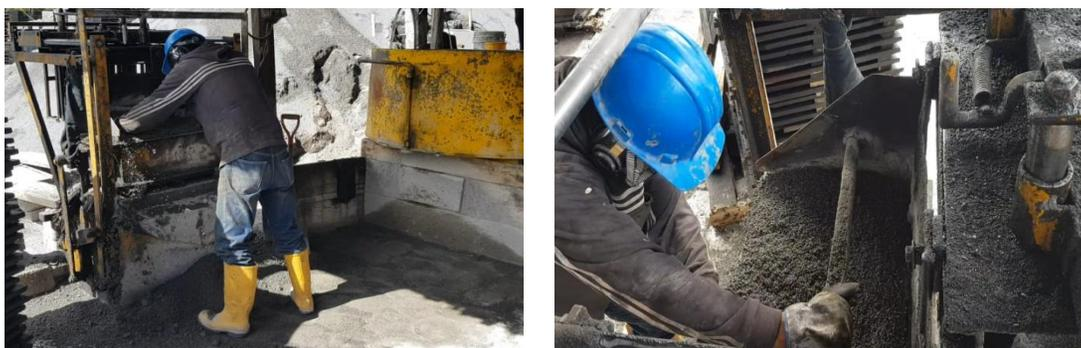
*Figura 63.* Trabajador retira el excedente de material del molde
