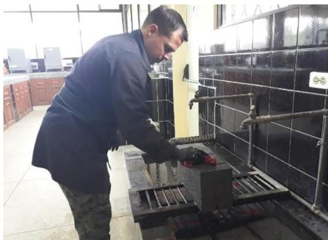
*Figura 99.* Retiro del agua visible del bloque con un paño húmedo
