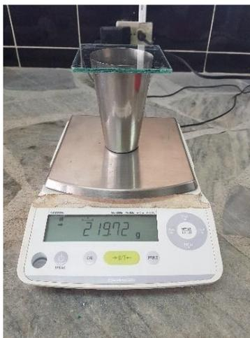
Figura 35. Registro del peso del vaso metálico más vidrio
