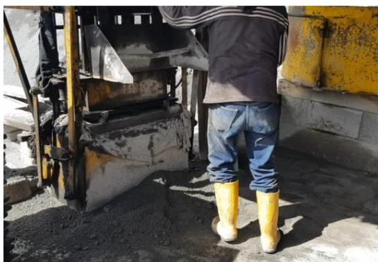
*Figura 60.* Trabajador ubica los moldes sobre el tablero
