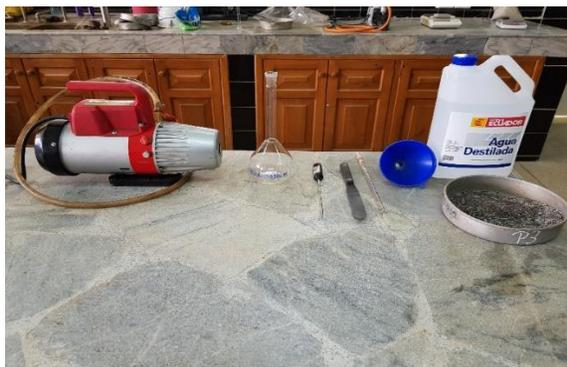
*Figura 27.* Equipo y materiales para el ensayo de densidad
