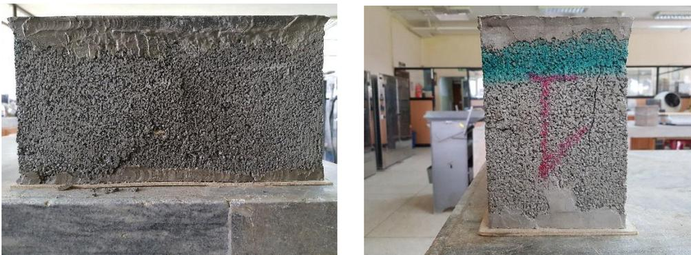
*Figura 130.* Plano de falla del bloque fabricado con arena, cascajo y 30% de ABS.
