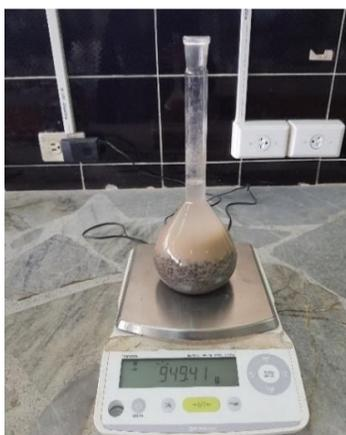
*Figura 34.* Masa del picnómetro con muestra más agua
