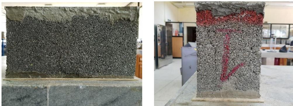
*Figura 138.* Plano de falla del bloque fabricado con arena, cascajo y 30% de PP.
