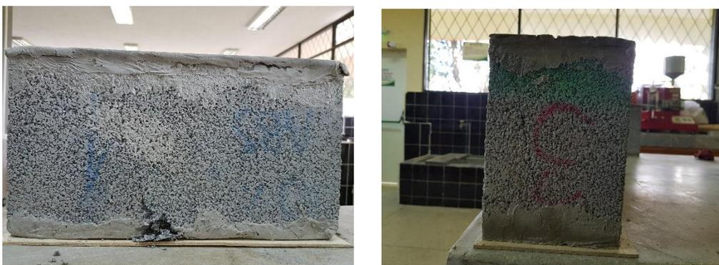
*Figura 126.* Plano de falla del bloque fabricado con arena y 30% de ABS.
