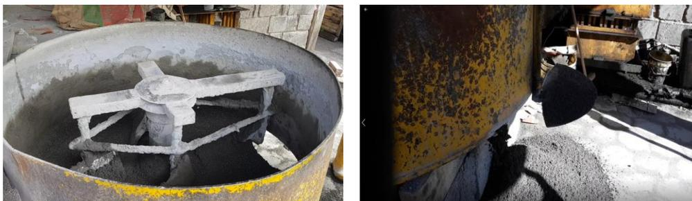
*Figura 58.* El compartimiento de la máquina mezcladora abierta para descargar la mezcla
