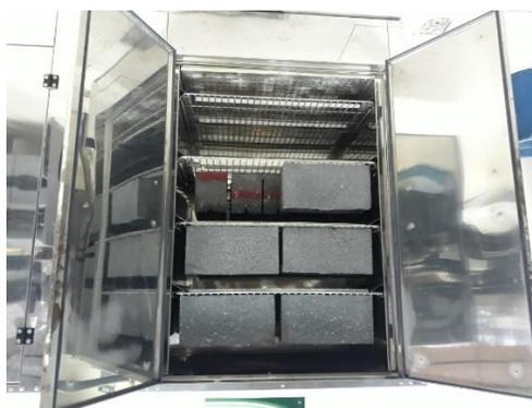
*Figura 100.* Secado de los bloques en un horno ventilado a 110°C
