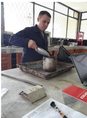
Figura 42. Estudiante introduce la muestra del residuo plástico al molde
