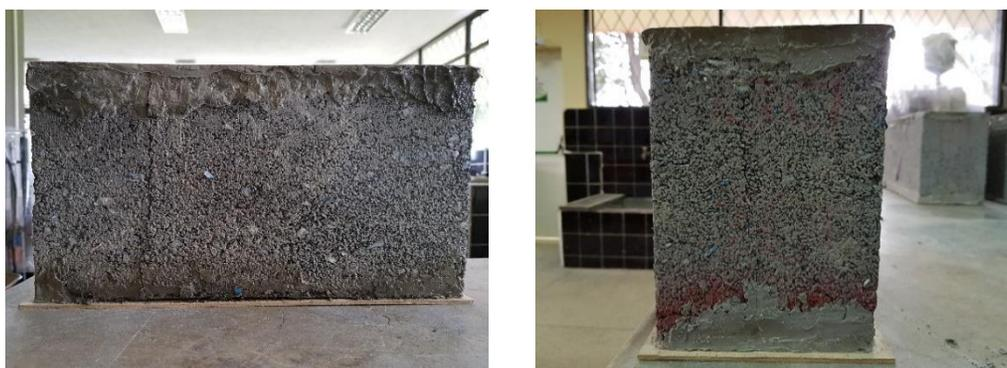
*Figura 132.* Plano de falla del bloque fabricado con arena y 10% de PP.
