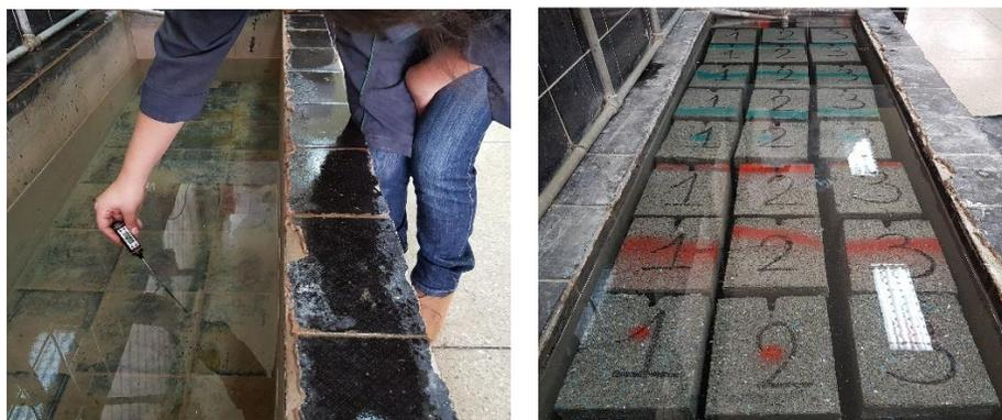
*Figura 97.* Toma de la temperatura del agua y los bloques sumergidos en agua por 24 horas
