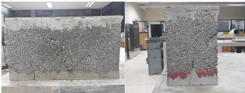
*Figura 136.* Plano de falla del bloque fabricado con arena, cascajo y 10% de PP.
