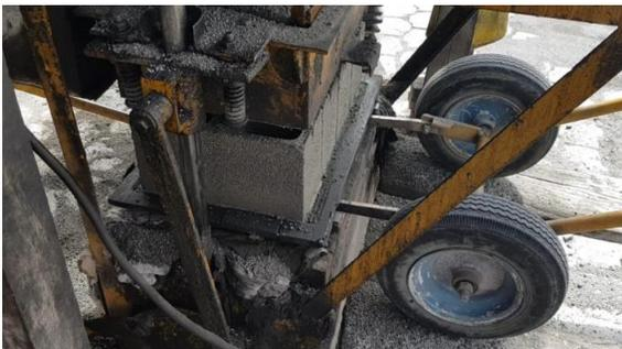
*Figura 66.* Retirar los moldes de los bloques
