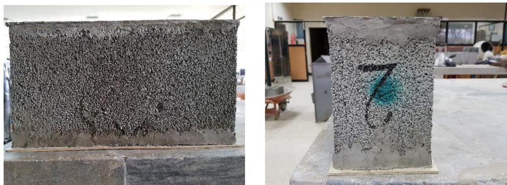
*Figura 131.* Plano de falla del bloque fabricado con arena, cascajo y 40% de ABS.
