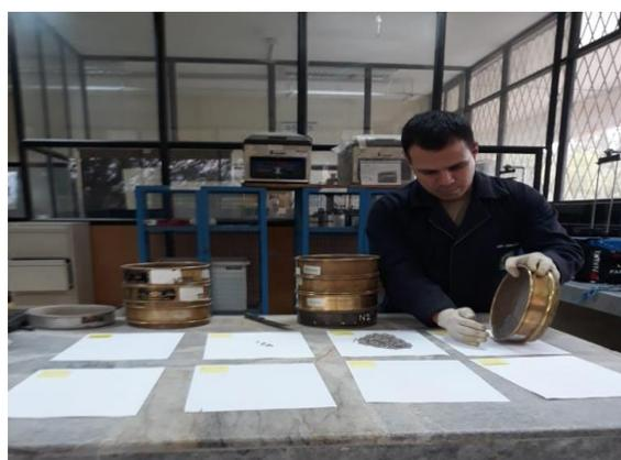
*Figura 23.* Estudiante realiza granulometría del agregado fino
