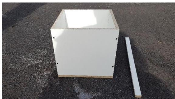
Figura 50. Parihuela de madera de  $30 \times 30 \times 30 \text{ cm}$
