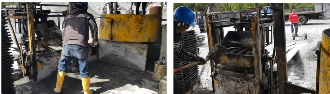
*Figura 62.* Trabajador alimenta la máquina bloquera con la mezcla
