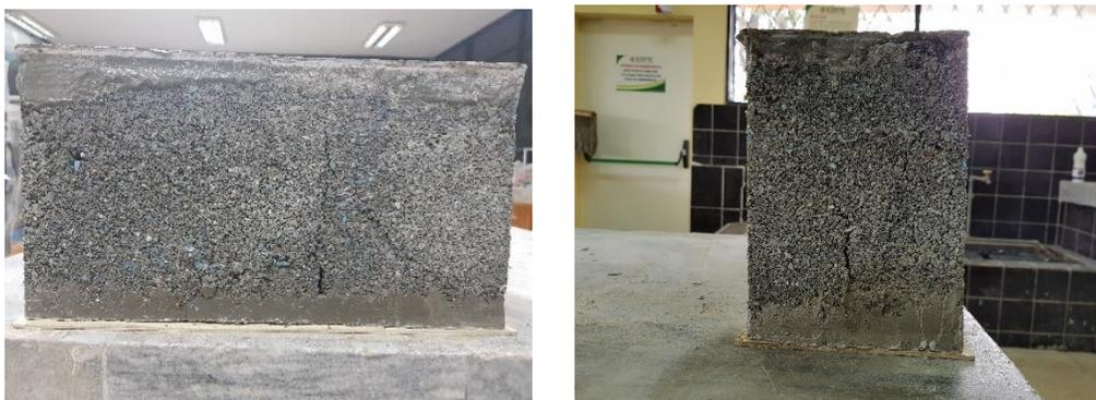
*Figura 139.* Plano de falla del bloque fabricado con arena, cascajo y 40% de PP.
