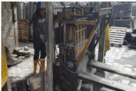
*Figura 64.* Trabajador comprime los bloques con el compactador
