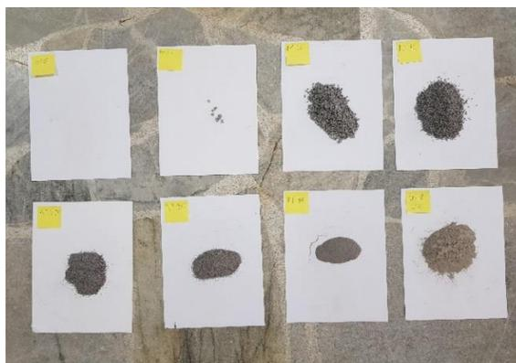
*Figura 22.* Granulometría del agregado fino de la cantera de Holcim-Palugo
