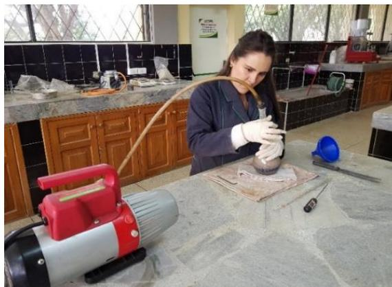
*Figura 32.* Estudiante agita el picnómetro mecánicamente
