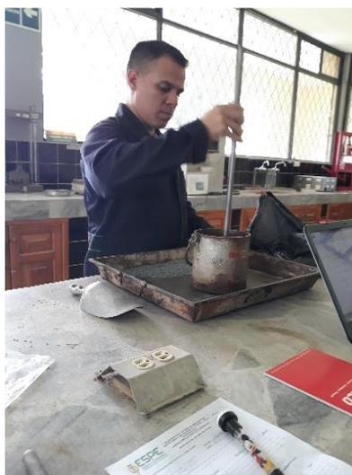
Figura 43. Estudiante varilla la muestra del plástico ABS
