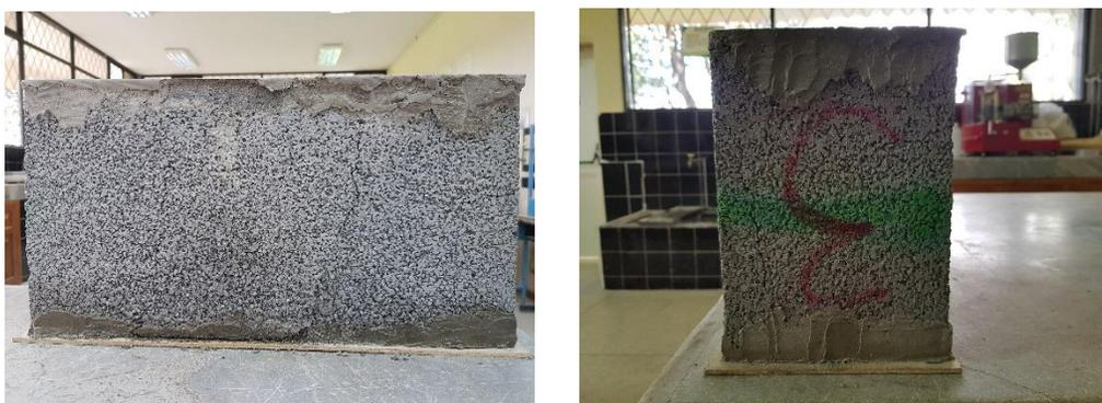
*Figura 125.* Plano de falla del bloque fabricado con arena y 20% de ABS.
