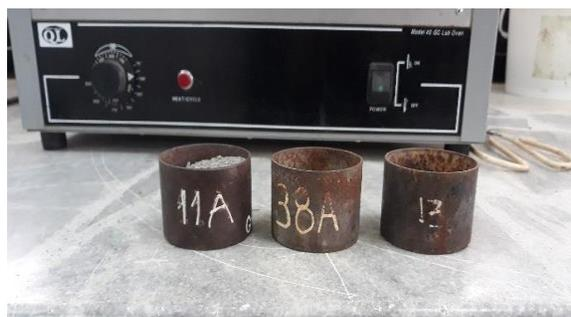
Figura 26. Taras con muestra de agregado fino para realizar el ensayo de humedad
