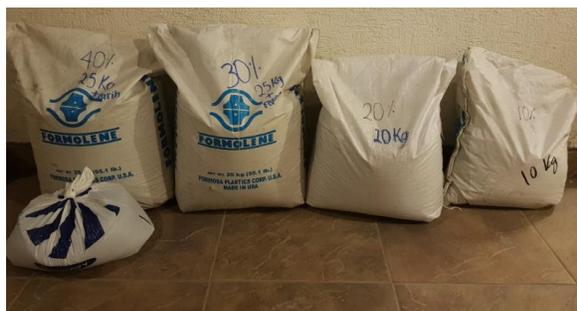
*Figura 53. Residuo plástico ABS para las diferentes dosificaciones*
