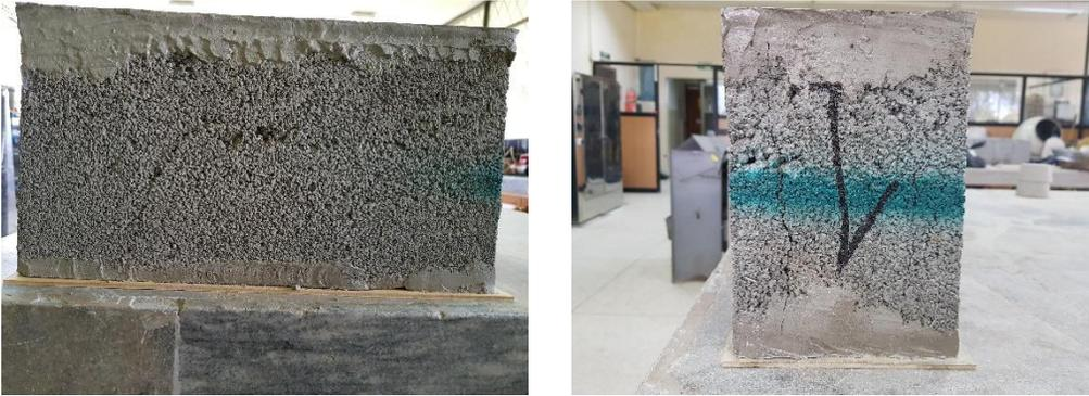
*Figura 129.* Plano de falla del bloque fabricado con arena, cascajo y 20% de ABS.
