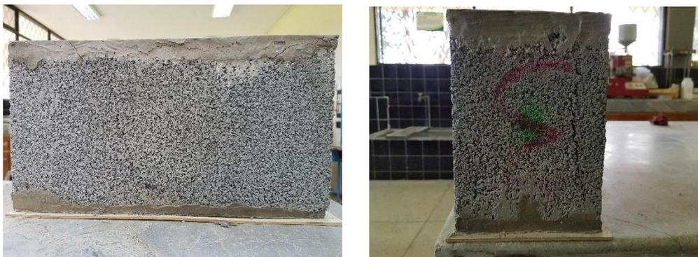
*Figura 127.* Plano de falla del bloque fabricado con arena y 40% de ABS.
