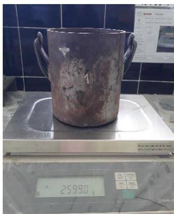
Figura 44. Registro del peso del molde vacío
