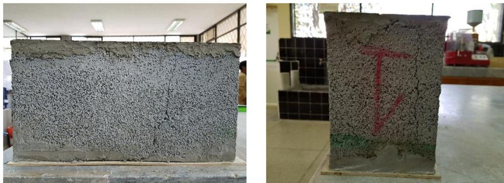
*Figura 124.* Plano de falla del bloque fabricado con arena y 10% de ABS.
