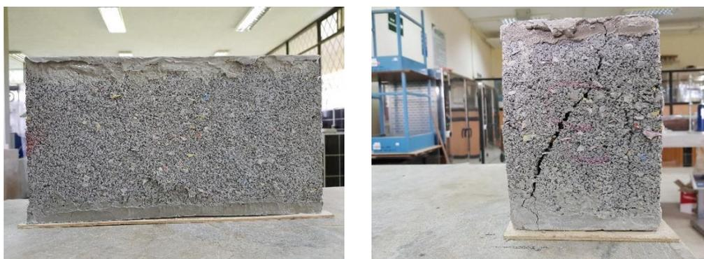
*Figura 133.* Plano de falla del bloque fabricado con arena y 20% de PP.
