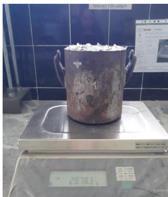
Figura 45. Registro del peso del molde más muestra
