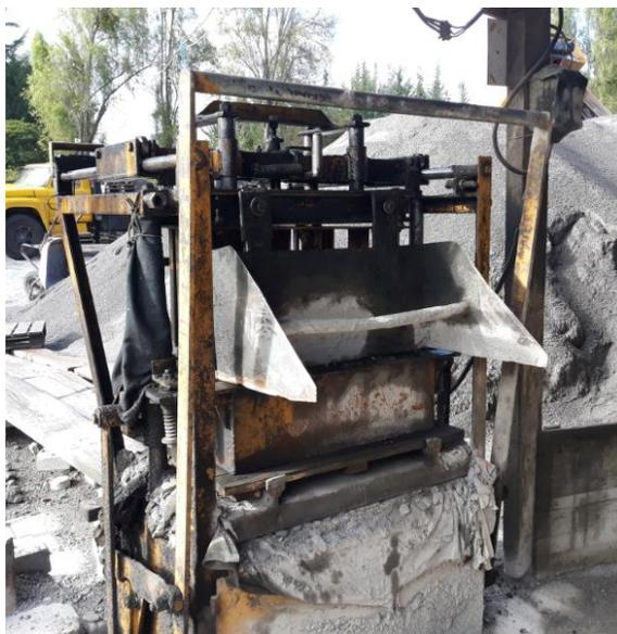
*Figura 73.* Máquina a motor eléctrico para fabricar bloques (equipo)
