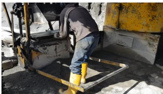
*Figura 59.* Trabajador coloca el tablero receptor sobre la mesa
