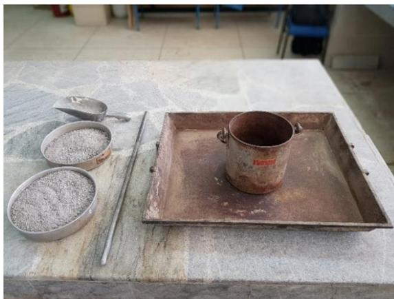
*Figura 39.* Equipo necesario para ensayo de masa unitaria
