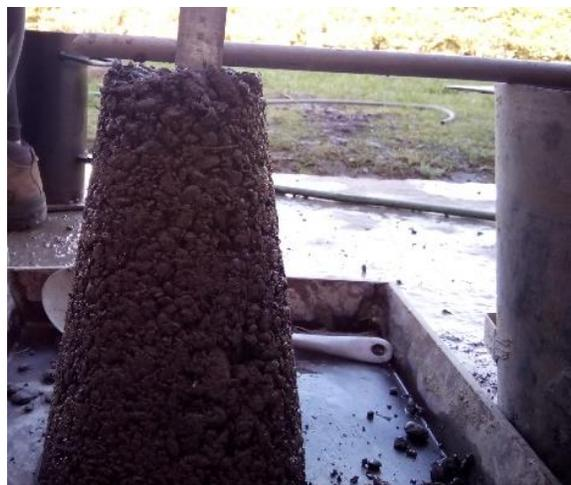
*Figura 57.* Comprobación del asentamiento mediante el ensayo del cono de Abrams
