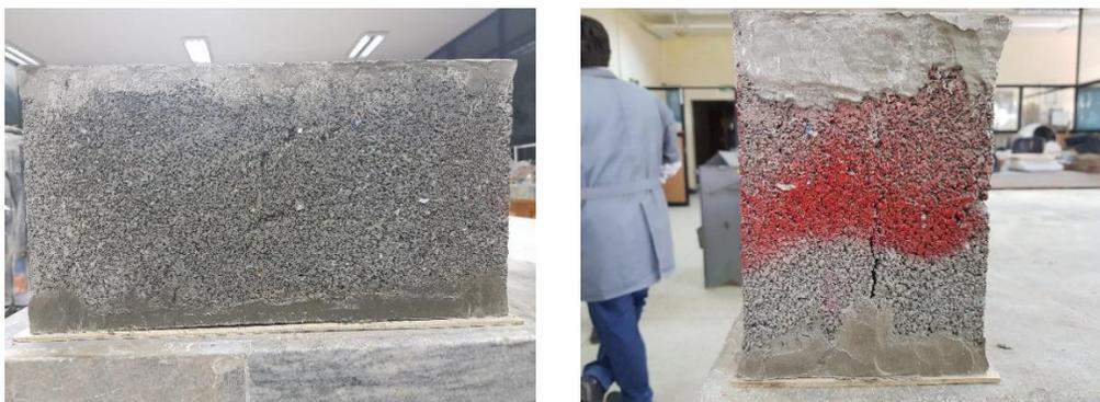
*Figura 137.* Plano de falla del bloque fabricado con arena, cascajo y 20% de PP.
