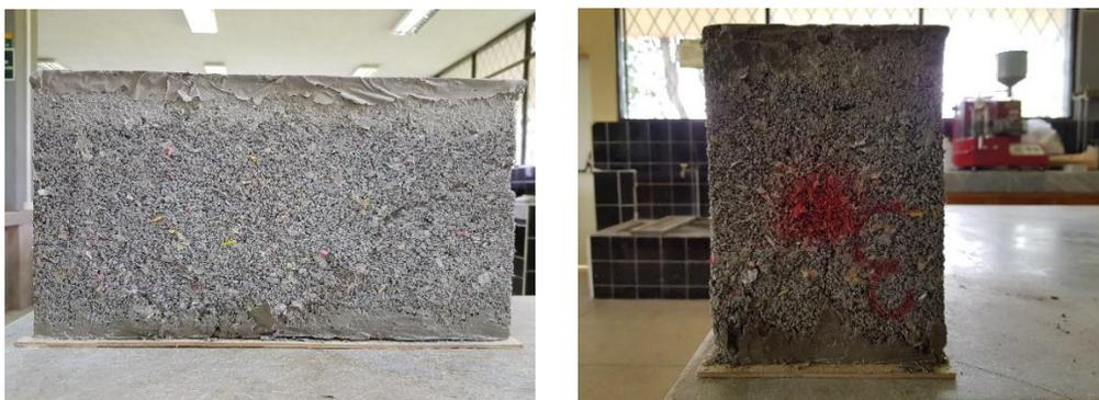
*Figura 135.* Plano de falla del bloque fabricado con arena y 40% de PP.
