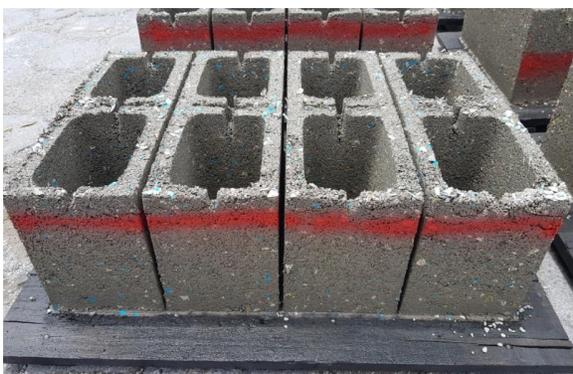
*Figura 72.* Rotulado de bloques con 10% de residuo plástico polipropileno (PP)
