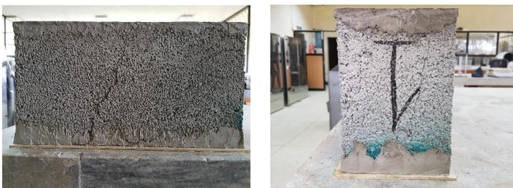
*Figura 128.* Plano de falla del bloque fabricado con arena, cascajo y 10% de ABS.
