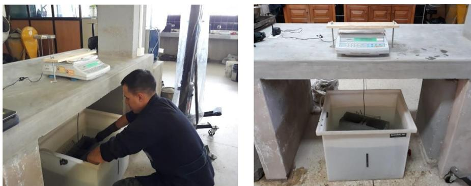
*Figura 98.* Toma de la masa de la muestra sumergida
