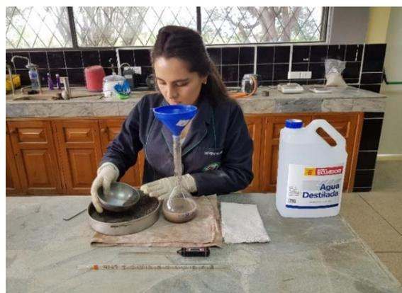
*Figura 31.* Estudiante coloca la muestra superficialmente seca dentro del picnómetro
