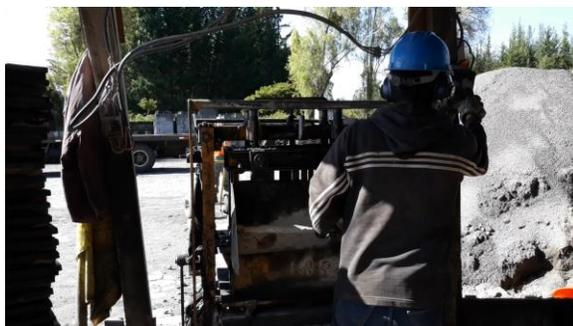
*Figura 61.* Trabajador acciona la máquina bloquera para empezar con la vibración
