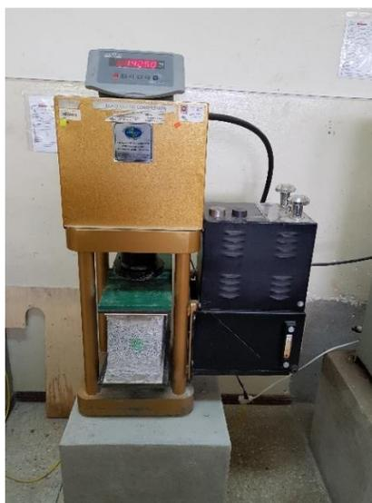
*Figura 115. Muestra sometida a la carga máxima en la máquina de compresión.*
