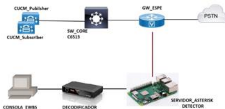
Figura 31. Diagrama de interconexión entre la interfaz y la red IP.
