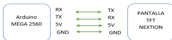
Figura 22. Esquema de conexión serial (UART) entre Arduino MEGA y pantalla TFT NEXTION
