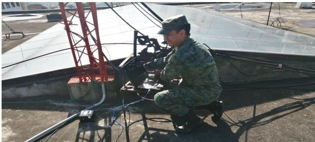
**Figura 43.** Toma de datos acelerográficos en la terraza del edificio de la Comandancia de Marina
