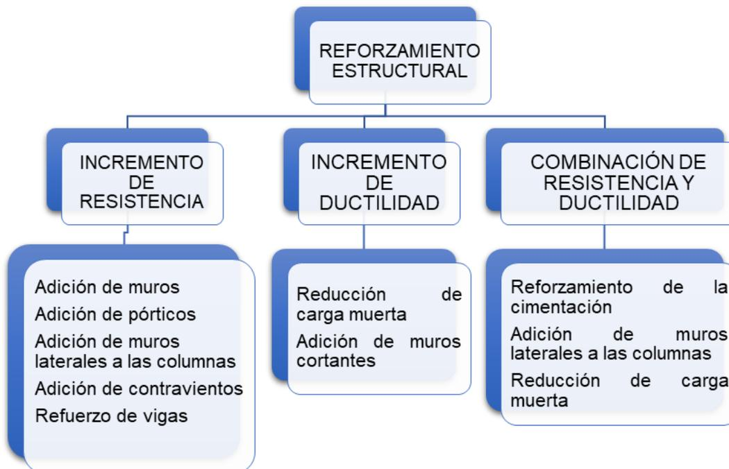
**Figura 58.** Tipos de reforzamiento estructural
