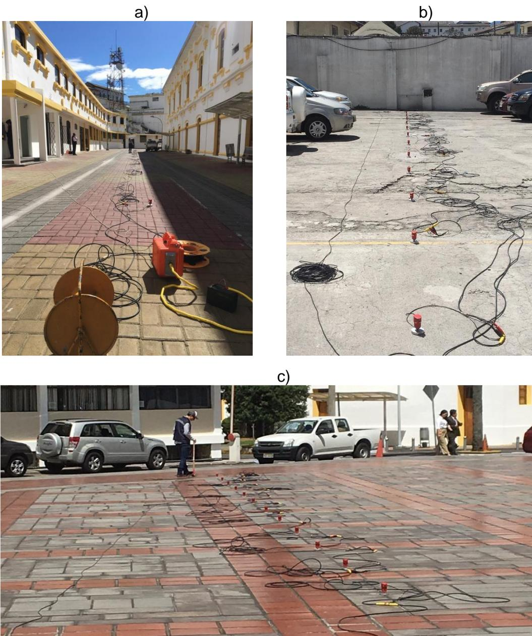
**Figura 17.** Tendido sísmico para el: a) Primer ensayo, b) segundo ensayo y c) tercer ensayo
