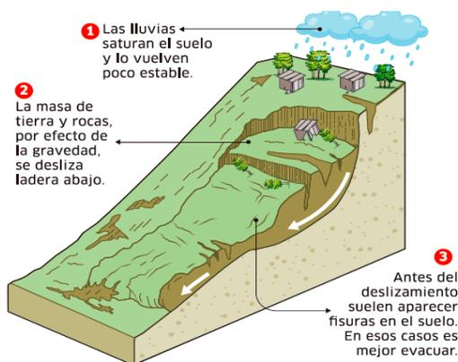
**Figura 8.** Deslizamiento debido a lluvia y señales de advertencia
