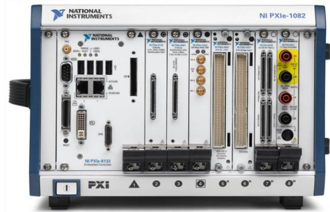
**Figura 45** Módulo PXI
