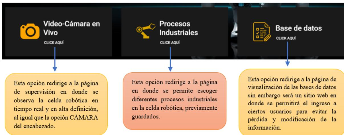
**Figura 63.** Esquema de navegación de las opciones inferiores el archivo index.html
