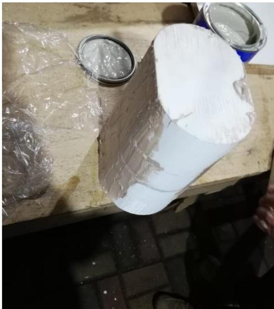
**Figura 44.** Masillado de las piezas a instalarse en el manipulador
