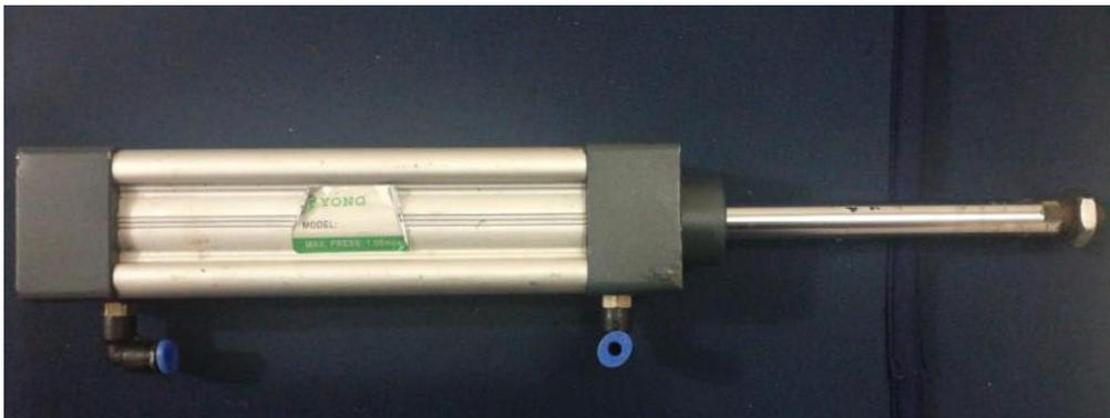
*Figura 165.* Pistón de doble efecto YONQ de 1MPa de presión
