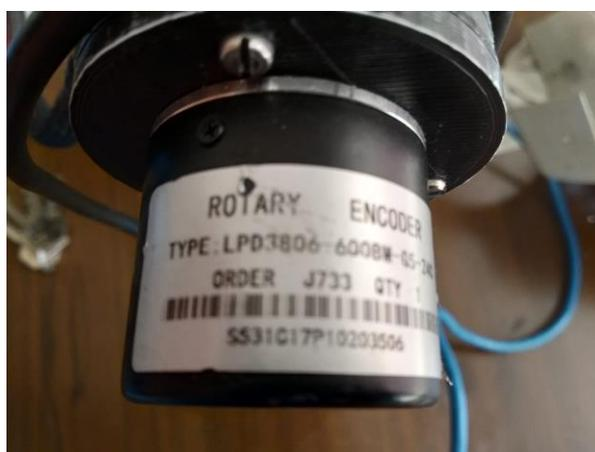
*Figura 9.* Encoder Rotary instalado en las articulaciones del codo y hombro
