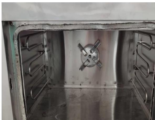
*Figura 116.* Instalación de agitador
