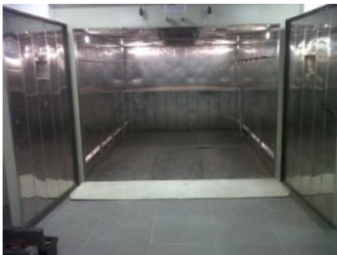
**Figura 11.** Cámara Interna de un Horno para Materiales Compuestos EMI.
