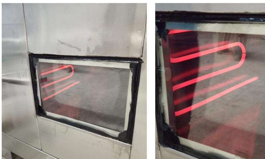
*Figura 123.* Resistencias al interior del horno
