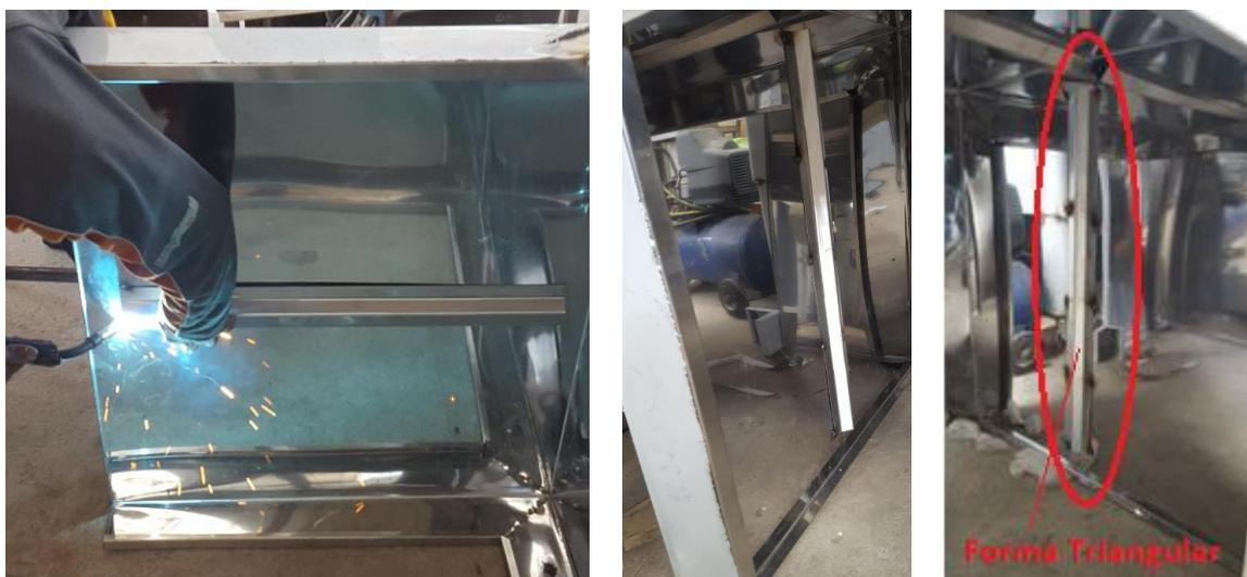
**Figura 101.** Soldadura de Refuerzos Interiores.
