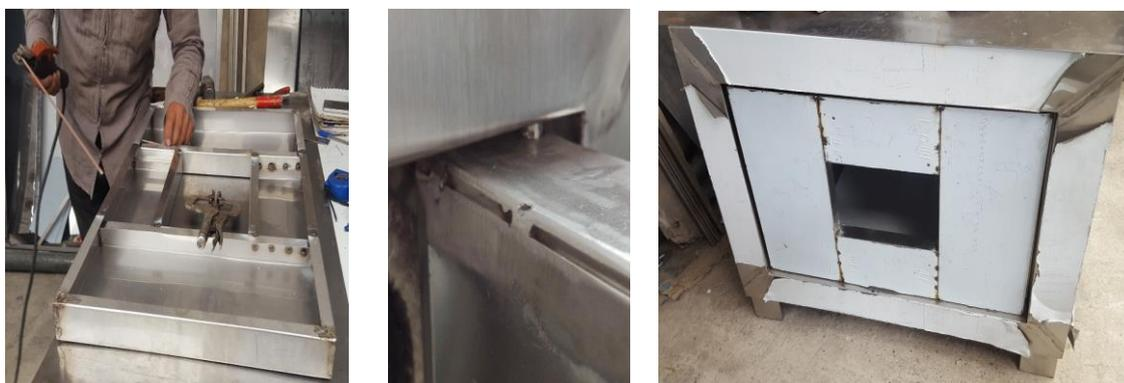
**Figura 109.** Montaje de la Puerta del horno
