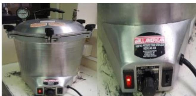
*Figura 1.* Autoclave del Laboratorio de Microbiología.
