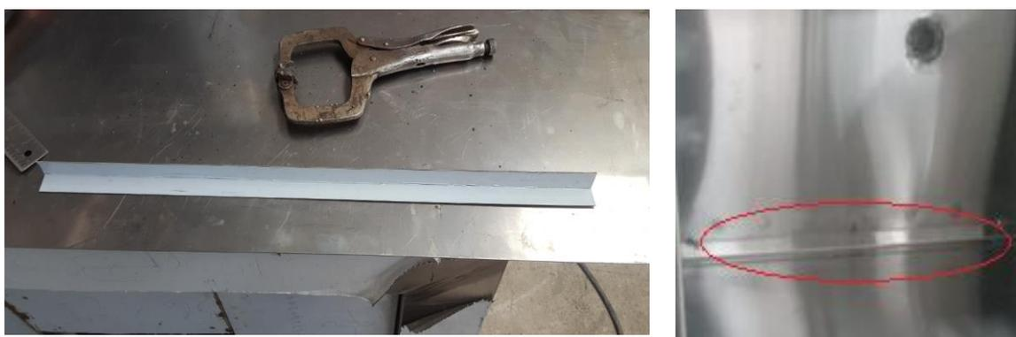
**Figura 110.** Refuerzos tipo L en el interior del horno
