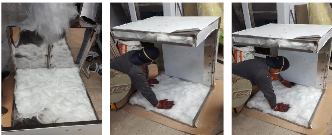
**Figura 103.** Aislamiento Térmico dentro del horno
