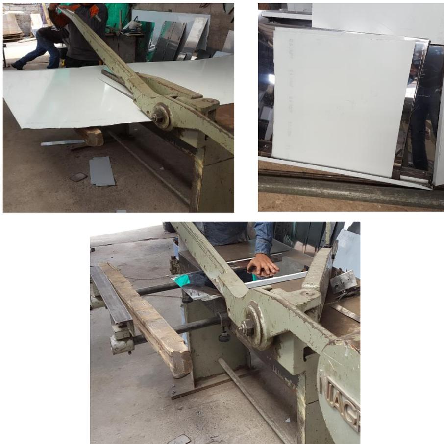
**Figura 97.** Corte según dimensiones
