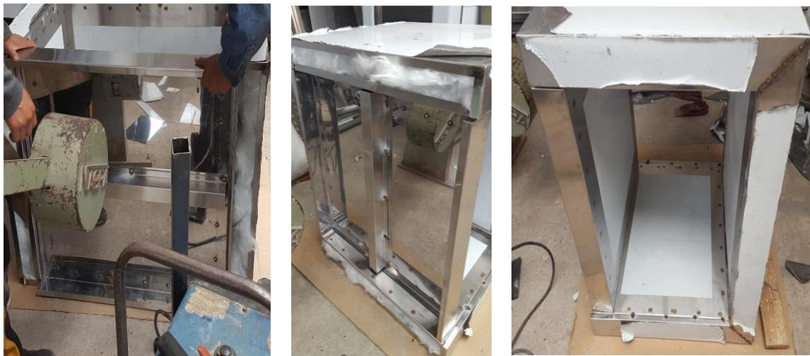
**Figura 106.** Horno con Aislamiento y Refuerzos
