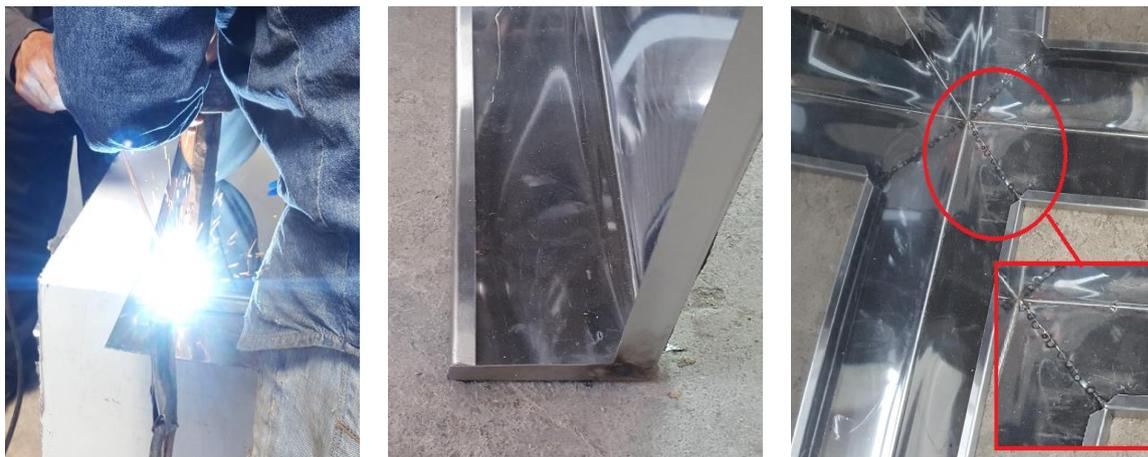
**Figura 100.** Soldadura de Aristas de Doblado.
