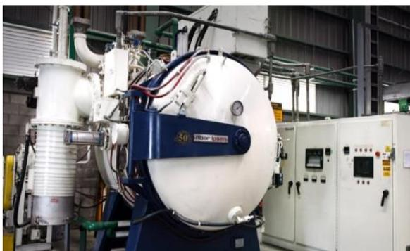
**Figura 6.** Horno al Vacío.
